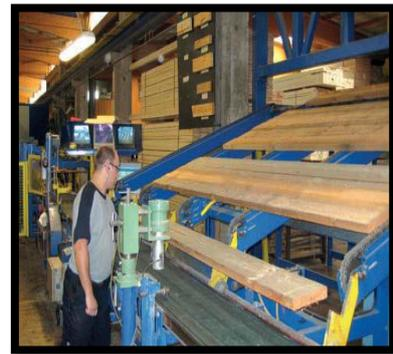
**Figure 36 :** Machine d'enturage
