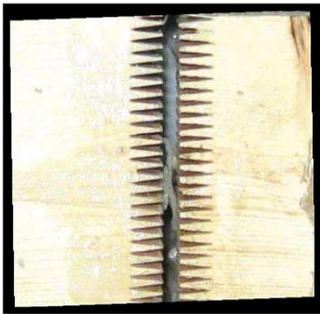
**Figure 34 :** Opération d'aboutage de lamelles
