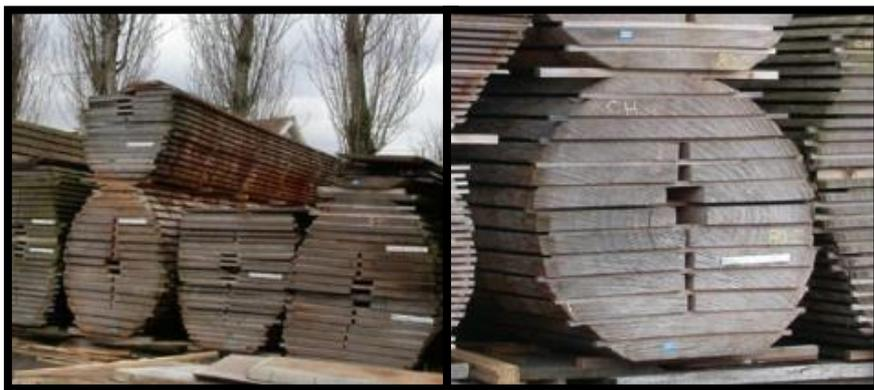
**Figure 14 : Découpage et séchage de troncs de chêne**
