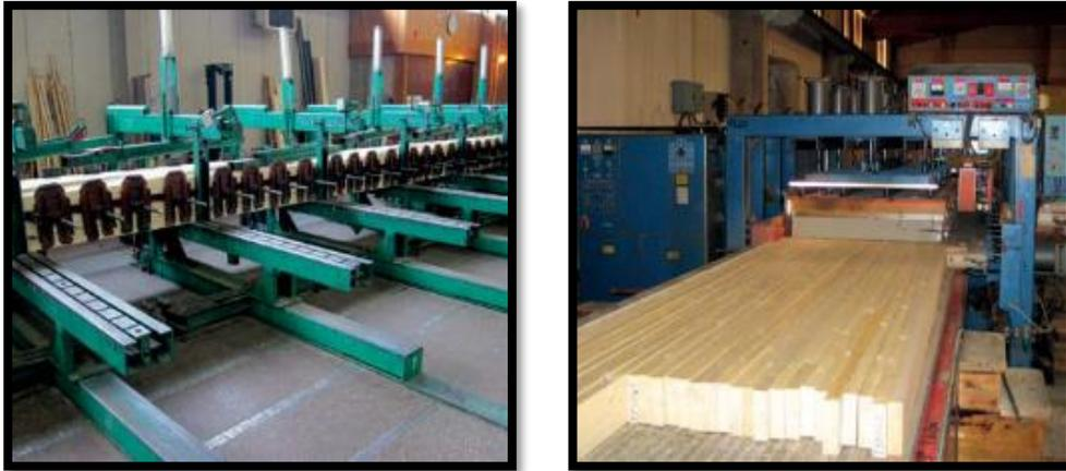
**Figure 39 : Serrage et séchage**
