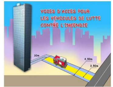
Figure 17 : schéma montrant la voie d'accès
