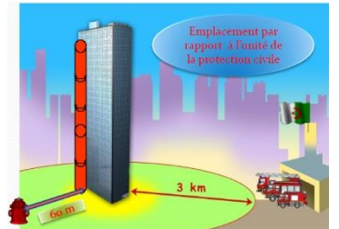
Figure 18 : la distance exigée entre le bâtiment et le centre de protection
