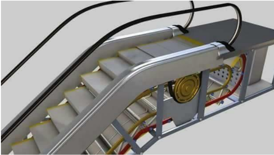
Figure 351 : le moteur qui fait fonctionner l'escalateur
