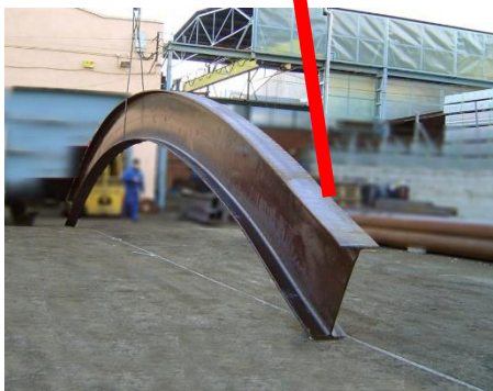
Figure 280 : utilisation des poutres contrés pour avoir une certaine inclinaison
