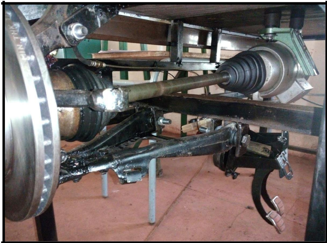
Figure 3.42: vue sur l'arbre de transmission et l'accouplement.
