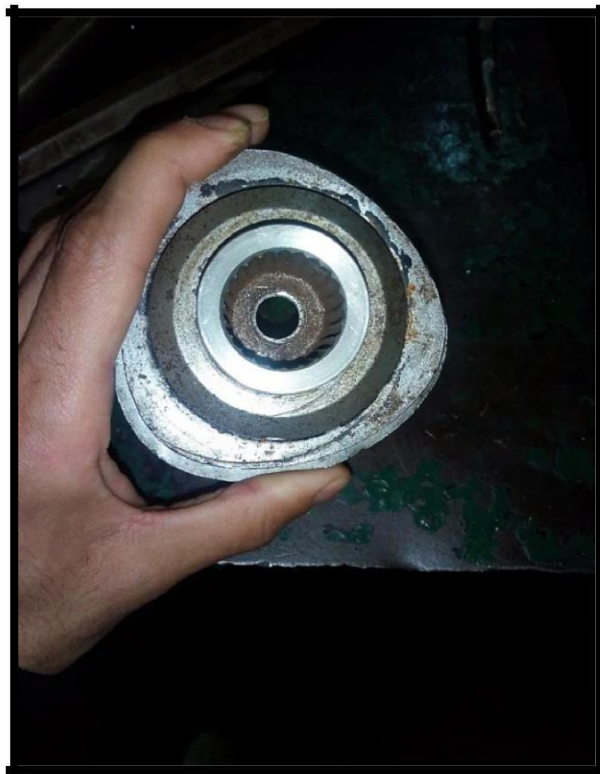
Figure 3.18: avant trou dans l'accouplement diamètre 10.
