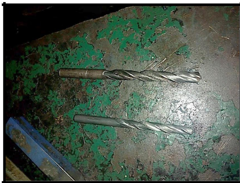
Figure 3.3: foret de diamètre 8 (en bas) et un foret de diamètre de 10 (en haut)
