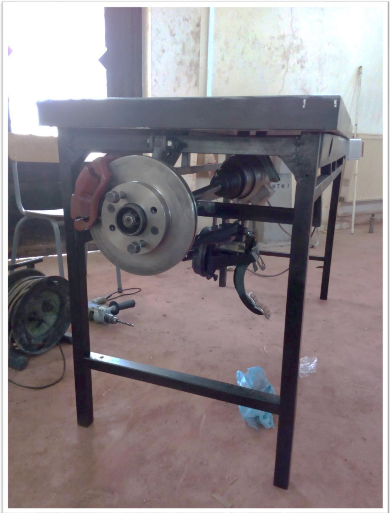
Figure 3.38: vue de droit du banc d'essai pour le système de freinage.
