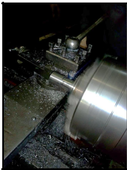
Figure 3.1: l'opération de chariotage.
