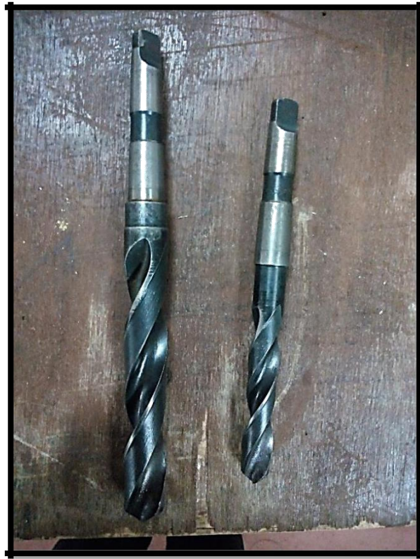
Figure 3.17: les forets utilisés, a la droite foret diamètre 10 à gauche foret diamètre 16.
