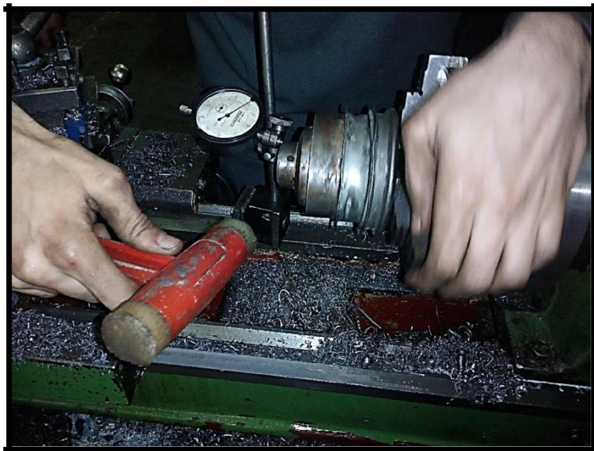
Figure 3.14: centrage de l'accouplement à l'aide d'un comparateur
