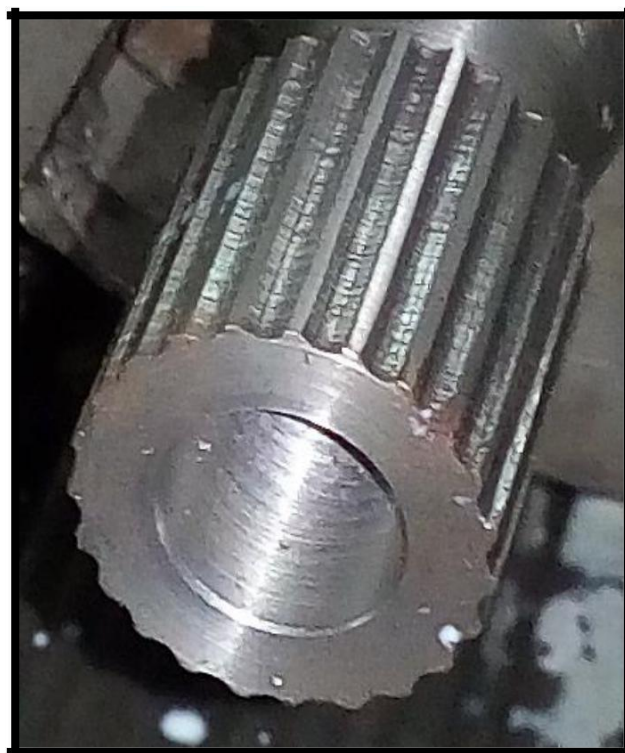
Figure 3.12: la pièce de l'accouplement à la fin de l'usinage
