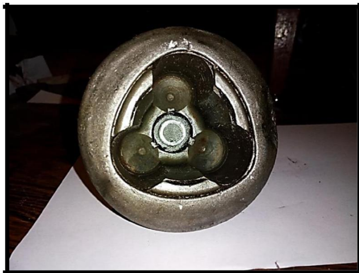
Figure 3.16: l'intérieur de l'accouplement avant l'usinage.
