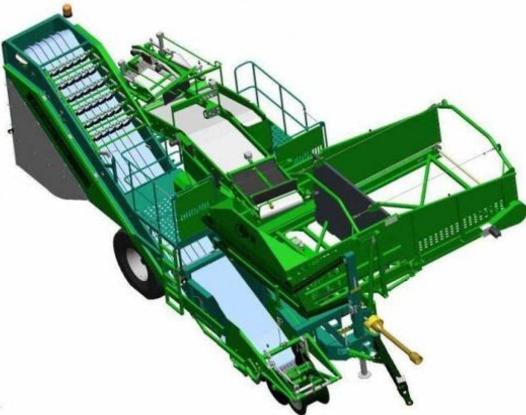
**Figure 1-5** : arracheuse ramasseuse de pomme de terre Spirit 6100 d`AVR
