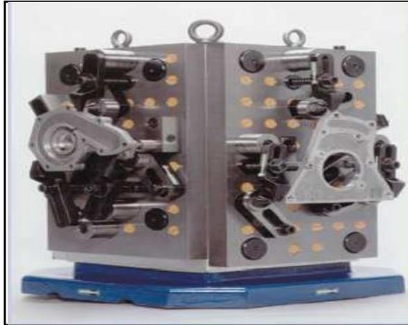
Figure 2.15 Groupement de pièces sur le même montage.
