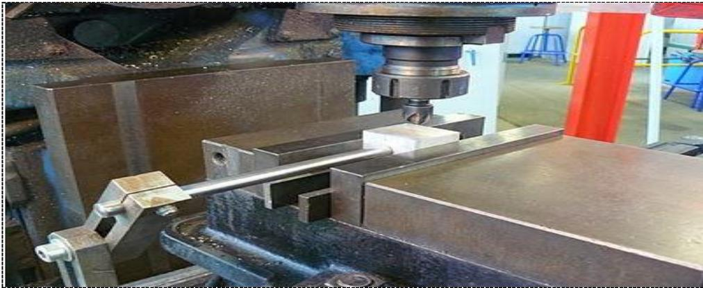
Figure 2.1 Système d'ablocage sur étai
