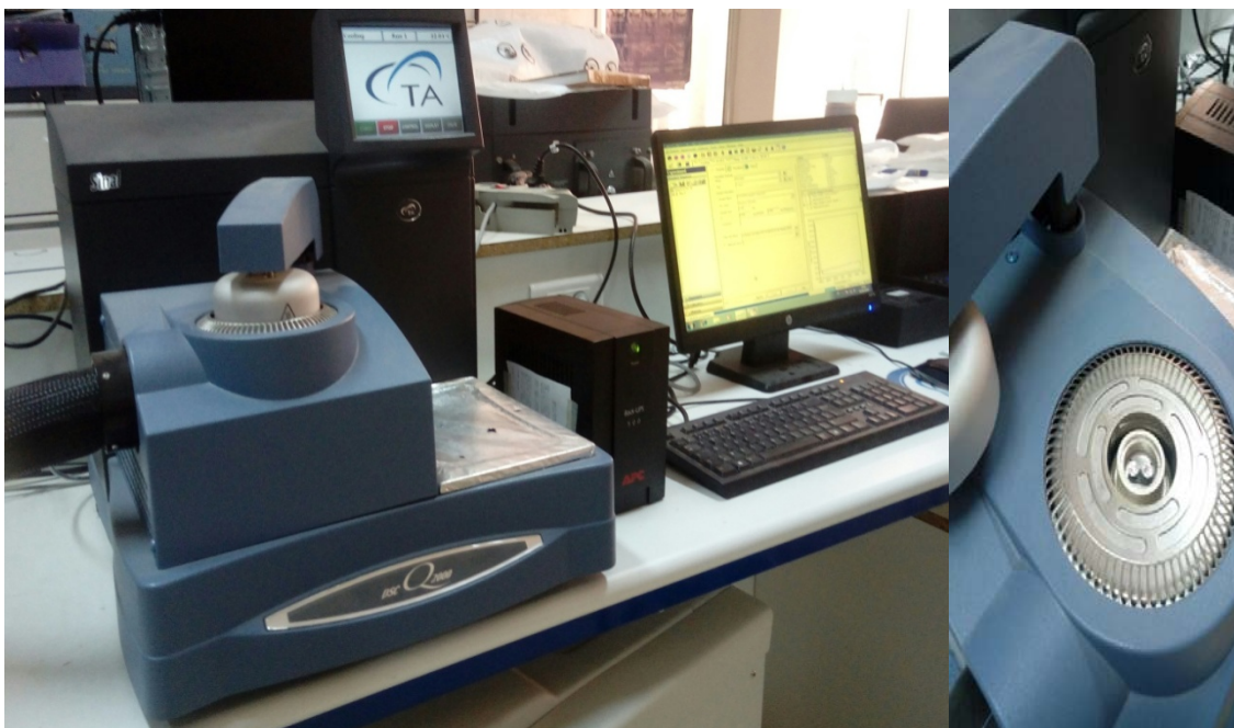
Figure III.18: Dispositif de mesure pour l'analyse enthalpique différentielle.
