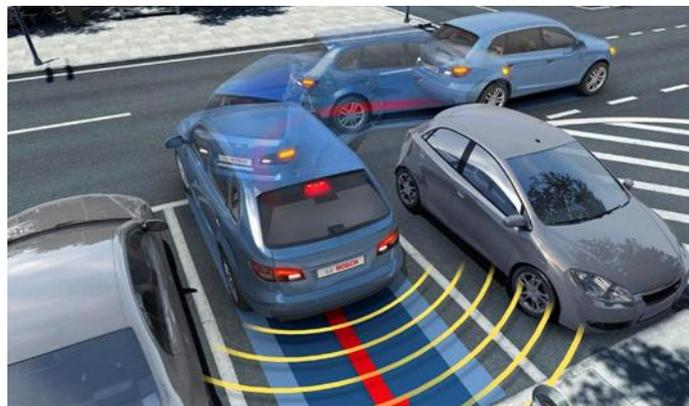
**Figure 01 : Manœuvre de stationnement en reculant avec radar de recul**
