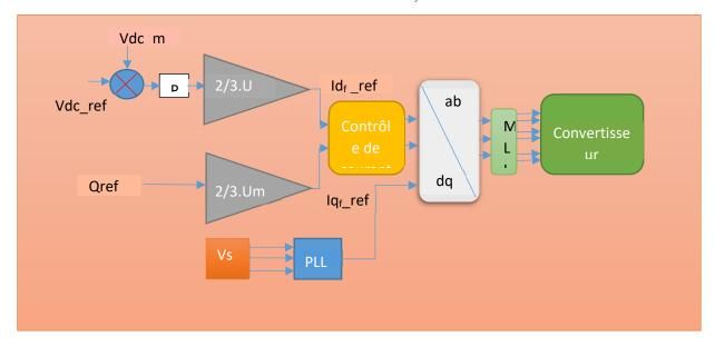
Figure III.21 : Commande de Convertisseur coté réseau
