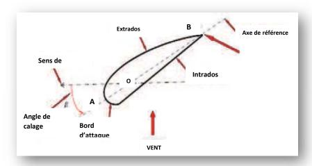
Figure II. 1 : Eléments constituant le profil aérodynamique d'une pale [6].
