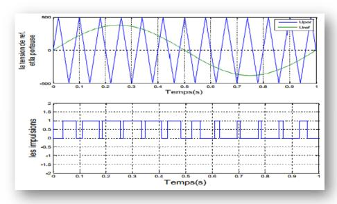
Figure III. 11: principe de la commande MLI- sinus-triangle [8]
