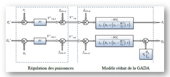
Figure III. 16: Contrôle des puissances statorique de la GADA ou MADA [47].
