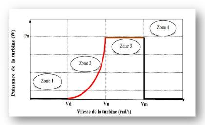
Figure II. 17 : Zone de fonctionnement d'une éolienne [10].
