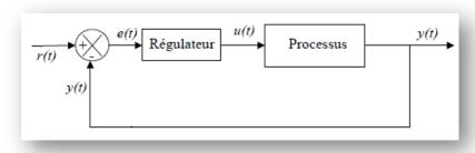
Figure II. 32: Schéma fonctionnel d'un processus réglé [8].
