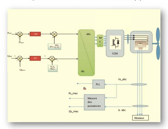
Figure III. 19 : Schéma bloc de la commande directe d'une éolienne à la base d'une MADA.
