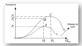
Figure II. 20: Caractéristique puissance vitesse de rotation d'une éolienne [33]
