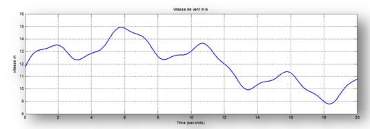
Figure II. 14: La vitesse de vent en fonction de temps suivant l'expression de Van Der Hoven avec  $V_0 = 12$ .
