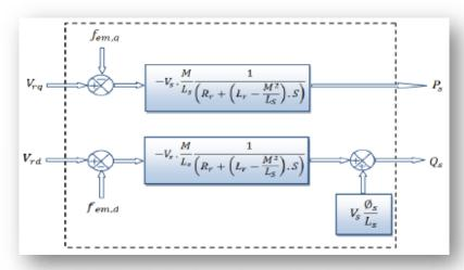
Figure III. 15: Modèle réduit des puissances statorique de la MADA [47].
