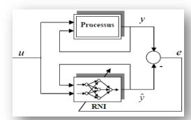
Figure II. 46: Principe de l'identification directe par modèle parallèle [39].
