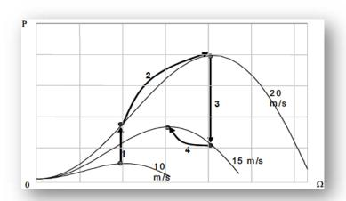
Figure II. 23: Principe de fonctionnement de MPPT à vitesse de vent variable [6].
