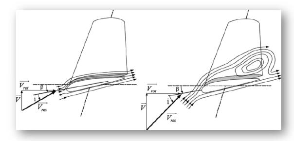
Figure II. 18: Flux d'air sur un profil de pale " stall "[12].
