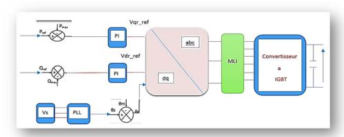
Figure III. 12: Principe de la commande du CCM [24]
