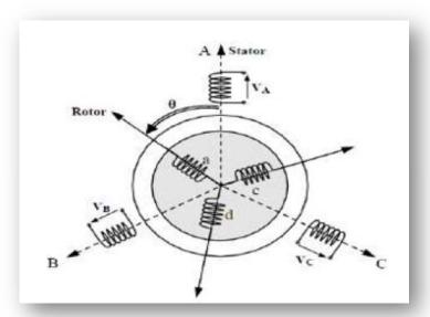
Figure III. 4 : Position des axes statoriques et rotoriques dans l'espace électrique [8].
