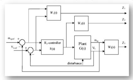
Figure II. 55: Diagramme simplifié de plant augmenté [34].
