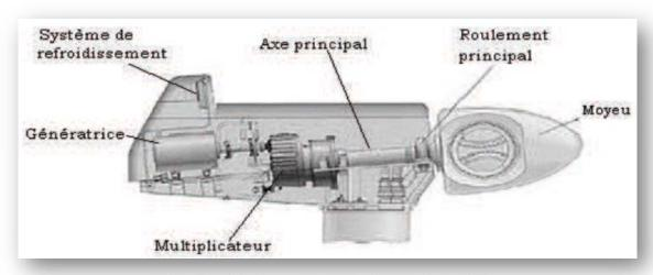
Figure II. 5: Principaux composants d'une éolienne [17].
