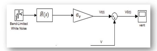
Figure II. 15: Schéma bloc de la vitesse de vent suivant l'expression de NICHITA [7]
