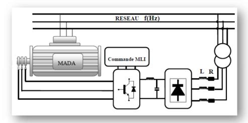
Figure III. 7: L'ensemble convertisseur machine [47]
