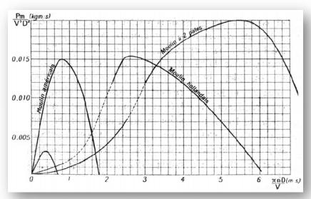
Figure I. 3 : Résultats d'essais sur la performance de différents types de rotor en fonction des vitesses de vent et de rotation obtenus dans le laboratoire Eiffel [1]
