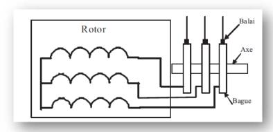
Figure III. 1: Structure du rotor d'une MADA [10].
