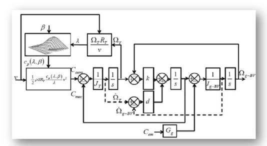
Figure II. 10: Schéma blocs du modèle souple de l'éolienne [7].
