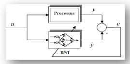
Figure II. 44 : Principe de l'identification directe par un réseau de neurones [39]
