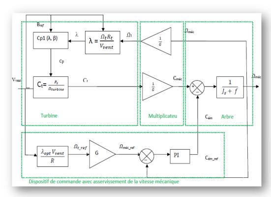
Figure II. 25 : Schéma bloc de la maximisation de la puissance avec asservissement de vitesse [9].
