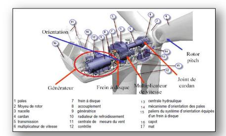
Figure I. 18 : Elément constitution d'une éolienne [10].
