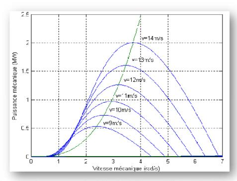
Figure II. 21: Courbes puissances /vitesse de rotation de la turbine pour déférente valeurs de la vitesse du vent [14].
