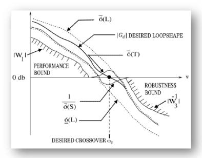
Figure II. 57: Spécifications de Loop shaping [35].
