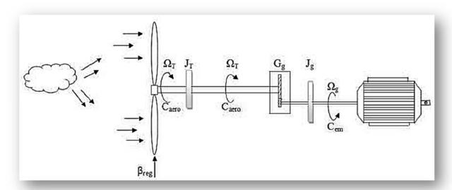
Figure II. 7 : Modèle rigide de l'éolienne
