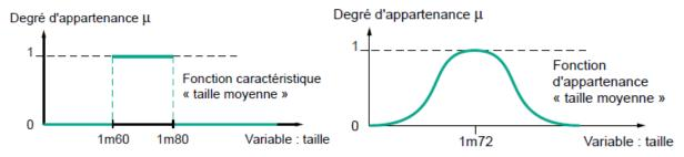
Figure II. 66: Fonction caractéristique [43]
