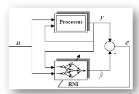
Figure II. 45 : Principe de l'identification directe par modèle série-parallèle [39].
