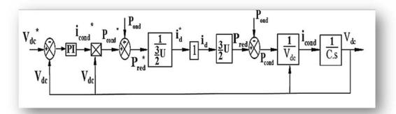
Figure III.22 : Schéma de commande de la tension aux bornes du condensateur
