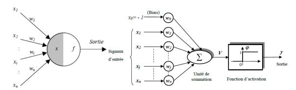
Figure II. 41: Modèle du neurone formel de Mac Culloch et Pitts avec biais [38][39].
