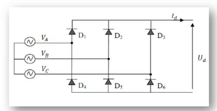
Figure III. 8: Représentation du redresseur triphasé à diodes [47]
