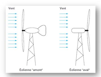
Figure I. 23: types d'éoliennes à axe horizontal [30].
