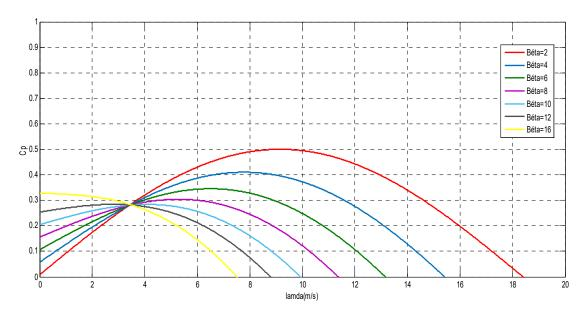
Figure II. 4 : Coefficient de la puissance en fonction de la vitesse relative de la turbine
