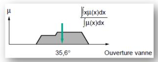
Figure II. 72 : Défuzzification par centre de gravité [43].
