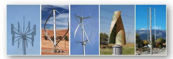
Figure I. 19: Petites éoliennes à axe vertical [6] [15] [17].
