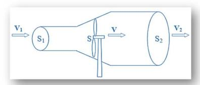
Figure II. 3 : Tube de courant d'air autour d'une éolienne [8].
