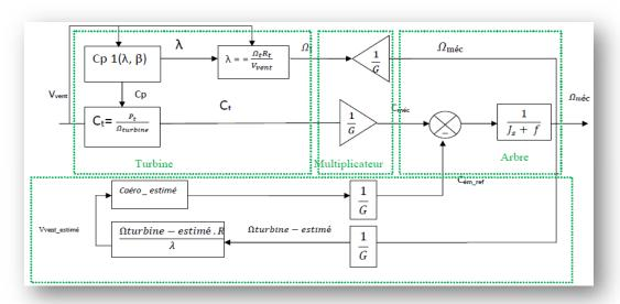
Figure II. 24 : Schéma bloc de la maximisation de la puissance sans asservissement de vitesse [9]
