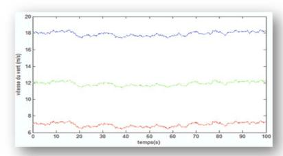
Figure II. 16: Génération de vents de différentes natures par la méthode de Nichita [7].
