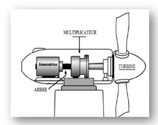
Figure II. 2 : Schéma d'une éolienne [8].
