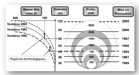
Figure I. 9 : Représentation schématique de l'évolution des prototypes en fonction de leurs puissances, diamètre et masse de l'ensemble nacelle/rotor [1].
