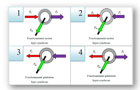
Figure III. 3: Modes opérationnels caractéristiques de la MADA [14].
