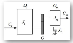
Figure II. 6 : Modèle mécanique de la turbine éolienne [8].
