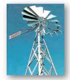
Figure I. 24: Eolienne lente [6].
