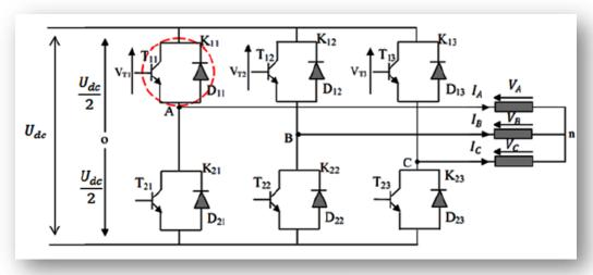
Figure III. 10: Onduleur de tension triphasé à deux niveaux [47].
