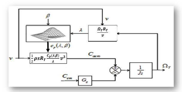
Figure II. 8 : Schéma blocs du modèle rigide de l'éolienne.
