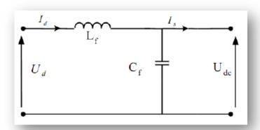
Figure III. 9: Représentation d'un filtre passe-bas
