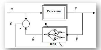
Figure II. 47: Principe de l'identification du modèle inverse par un réseau de neurones [39].
