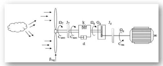
Figure II. 9 : Modèle souple de l'éolienne
