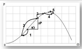
Figure II. 22: Principe de Maximisation de puissance d'une éolienne sans connaissance courbe Cp [6].
