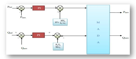
Figure III. 18: Schéma bloc de la commande directe d'une MADA [47].
