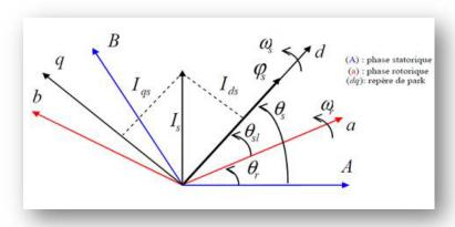
Figure III. 13: Orientations de l'axe d sur le flux statorique [8]
