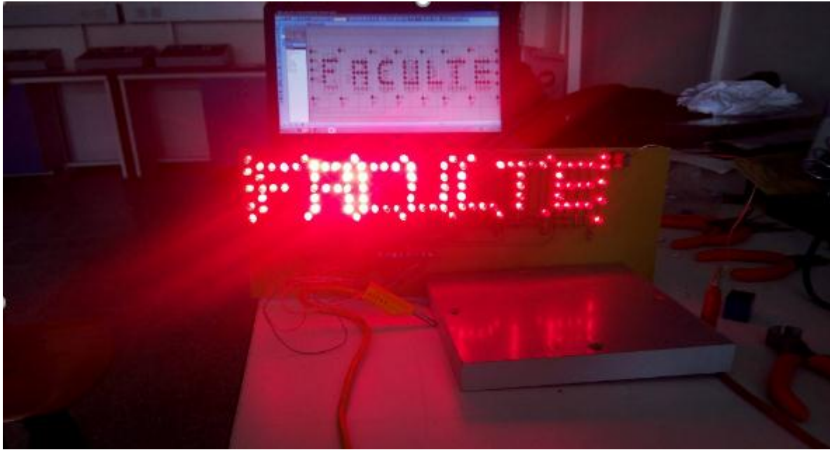
Figure 3-11:photo de la réalisation de la carte affichage
