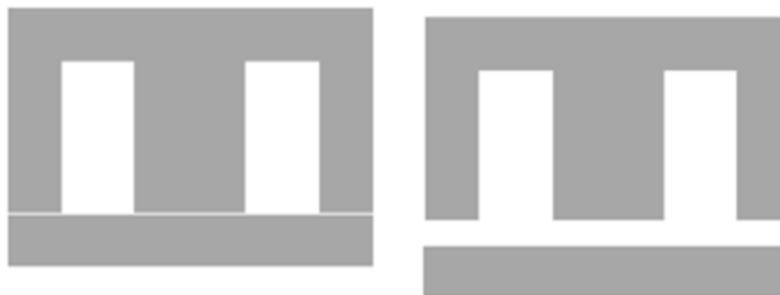
Figure II.19 : Schémas des tôles d'un transformateur monophasé
