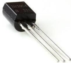
**Figure II.8** : Image d'un transistor bipolaire
