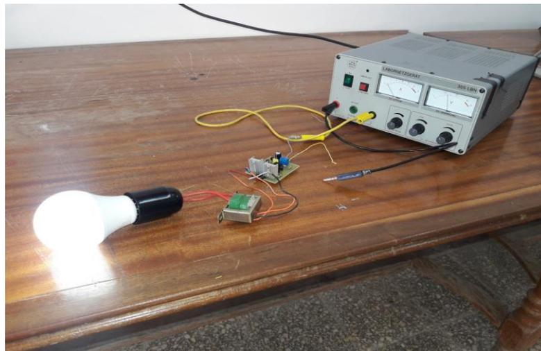
**Figure III.13 :** Test du fonctionnement de notre mini onduleur
