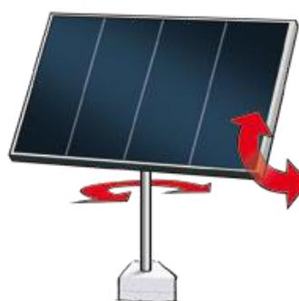
**Figure(III.16) :orientation d'un panneau solaire[15].**
