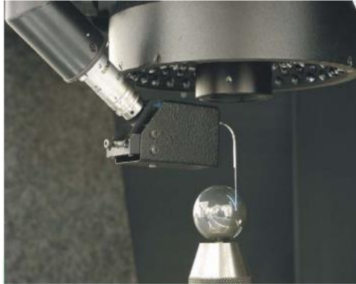
Figure 2.9 palpeur à fibre optique [25]
