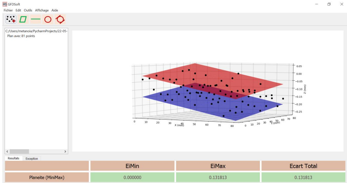
Figure 4.19 Résultat du traitement de 81 points de la face sciée par le critère Minimax
