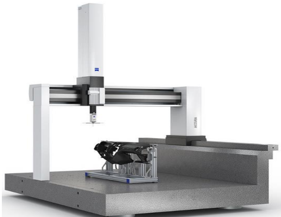
Figure 2.4 MMT de type pont mobile [19]
