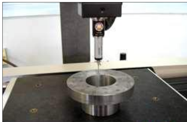
Figure 4.10 Contrôle de la planéité du palier sur MMT du Laboratoire de Métrologie (ENP d'Oran) [8]
