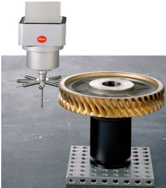
Figure 2.7 palpeur à mesure statique [25]
