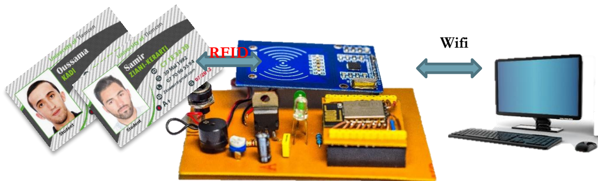
Figure III-13 le schéma descriptif de fonctionnement de notre système
