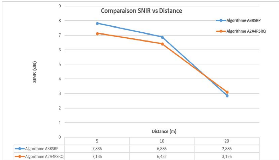
Figure 3. 11 : Comparaison RSRP Vs RSRQ, SINR en fonction de la distance.
