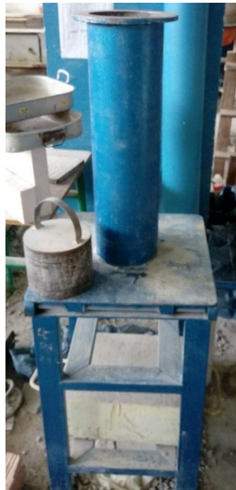
Figure III.7 : Table à secousses et piston de 20 Kg (méthode LPC n°61).
