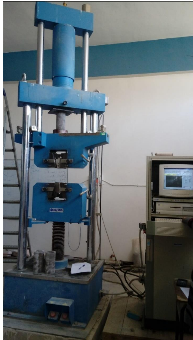
Figure III.19 : Essai de compression des éprouvettes cylindriques du béton.
