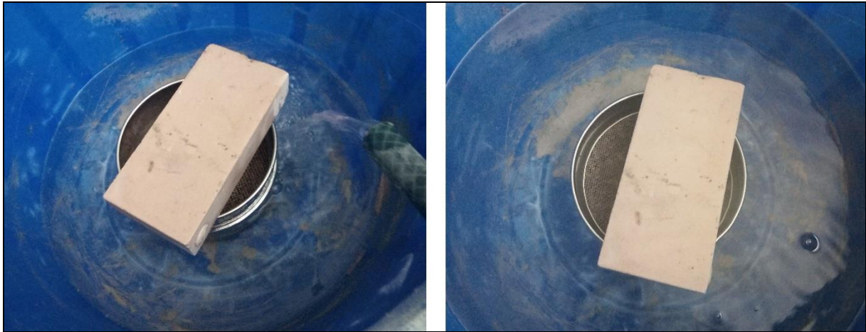
Figure III.13 : Immersion des échantillons de liège dans l'eau pendant 24h.
