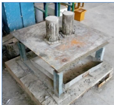
Figure III.14 : Mise en œuvre des bétons dans leurs moules
