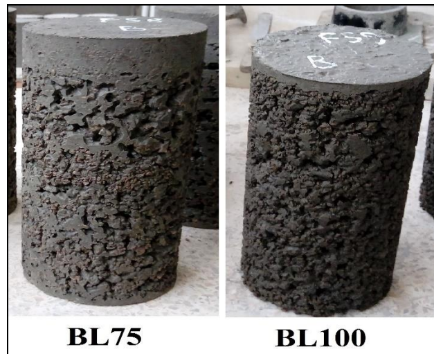
Figure IV.15 : Epreuves à fort taux de substitution de granulats de liège ( \geq 75\% )
