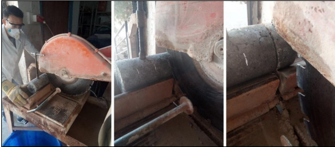
Figure III.21 : Cisaillement des éprouvettes avec la scie à béton
