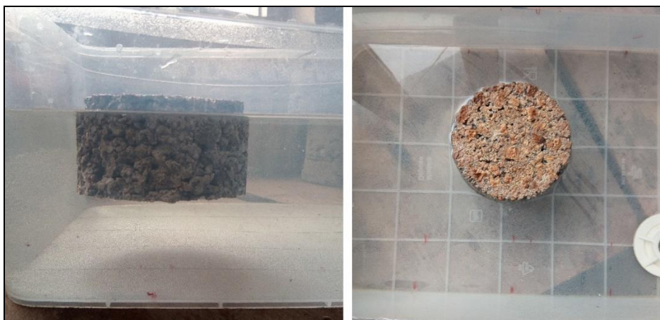
Figure IV.14 : Flottement du béton à base de granulats végétaux (à 100 %).
