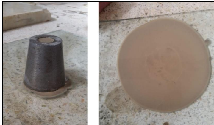
Figure III.3. Essai d'étalement au mini-cône.
