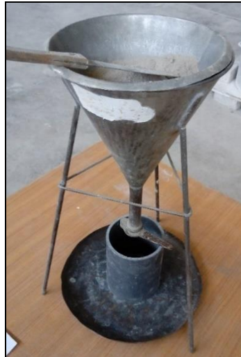
Figure III.1 : Caractérisation de la masse volumique apparente du ciment.
