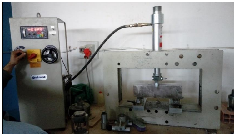
Figure III.20 : Essai de traction par flexion du béton
