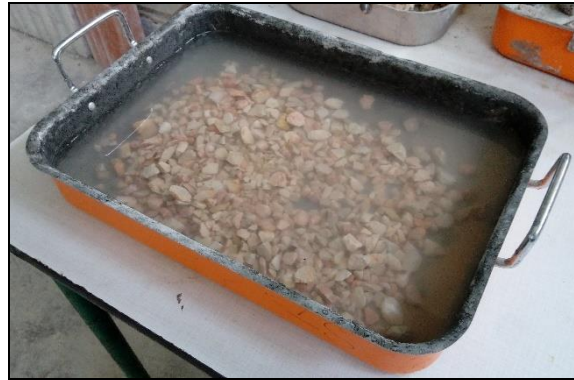
Figure III.8 : Absorption des granulats minéraux
