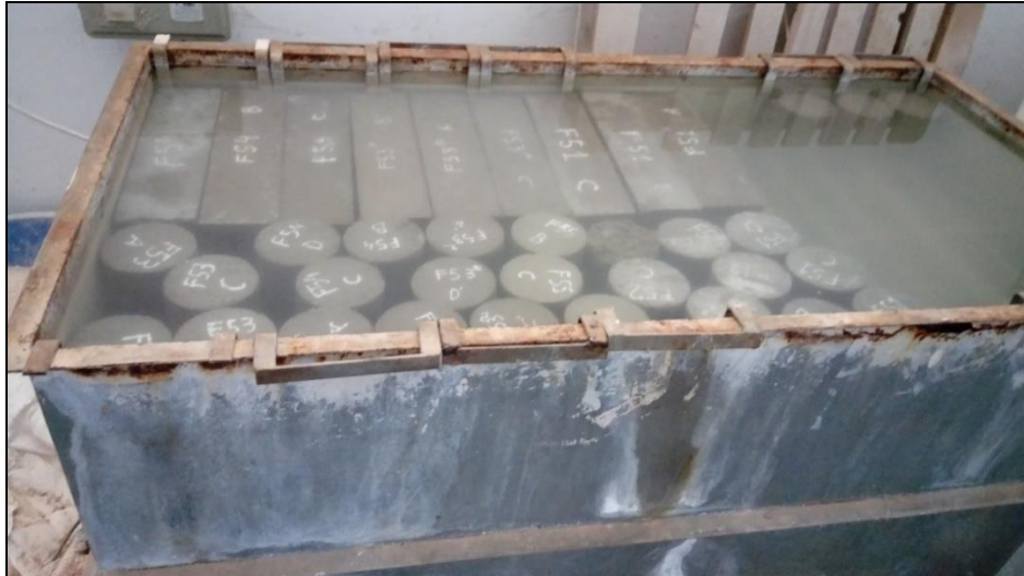
Figure III.15 : Conservation des éprouvettes au laboratoire par immersion dans l'eau.
