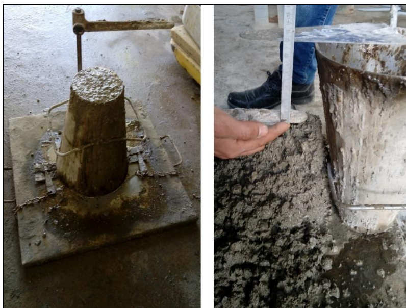
Figure III.16 : Mesure de l'affaissement au cône d'Abrams
