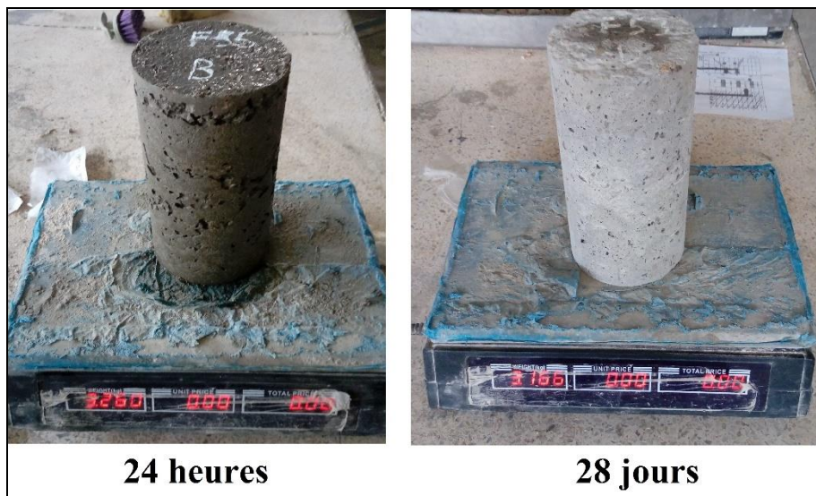
Figure III.18 : Pesée des éprouvettes en béton.
