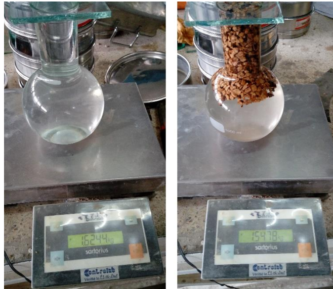
Figure III.12 : Méthode du ballon.
