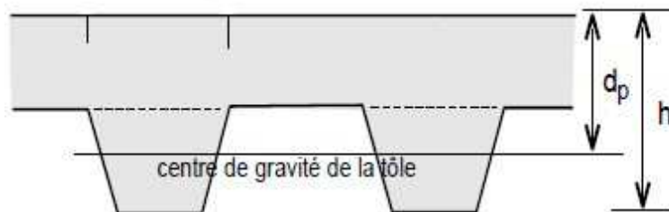
Figure 5. 6 : Caractéristiques géométriques de la dalle mixte
