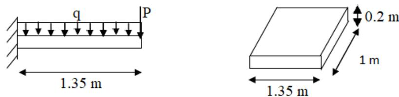
Figure VII.2: Schéma statique de la dalle pleine
