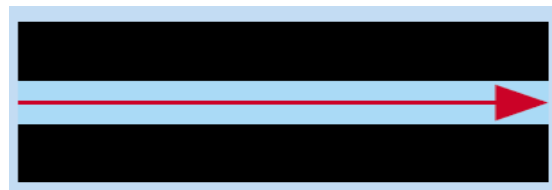
Figure 1.4 : Trajet du signal dans une fibre monomode.
