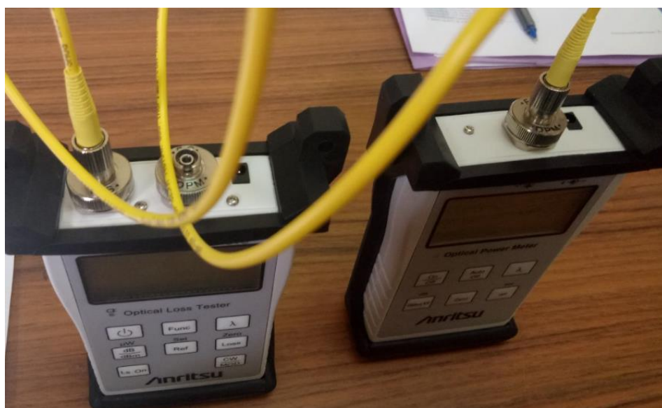
Figure III.8 : Méthode expérimentale de mesure de pertes d'insertion optiques
