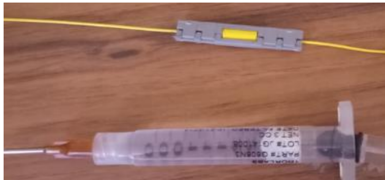
Figure III.35 : Etape « 4 » de l'épissure mécanique
