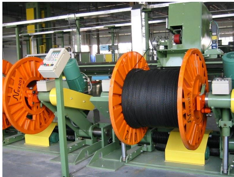
Figure II.2 : 2 ème étape de fabrication (le fibrage)
