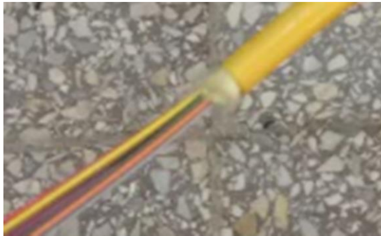
Figure III.22 : Câble souple à 12 brins de fibres optiques
