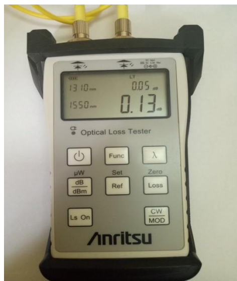
Figure III.6 : Mesure de pertes optique
