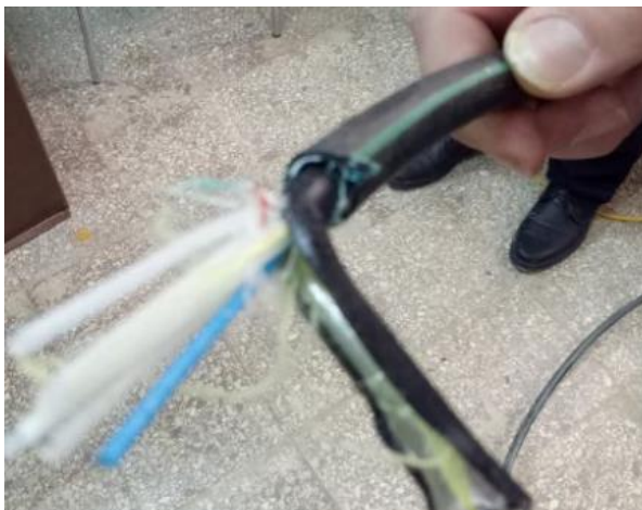
Figure III.23 : Câble semi-rigide à 4 brins de fibres optiques.
