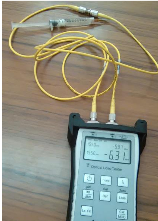
Figure III.13 : Mesure de la puissance reçue à l'aide de la source laser/testeur de pertes
