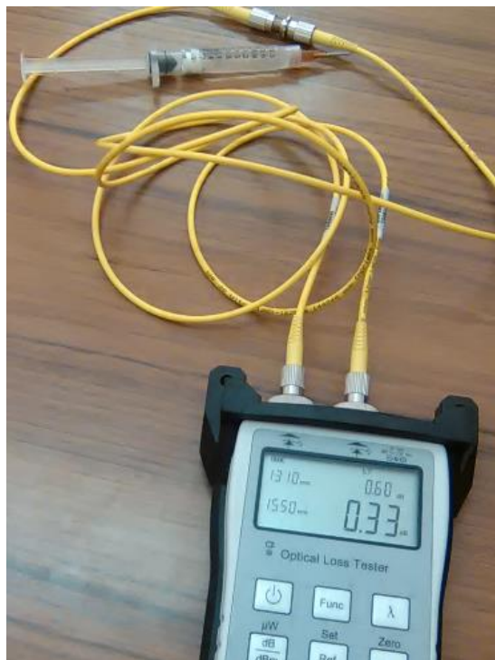
Figure III.14 : Mesure de pertes optique de deux fibres et un adaptateur avec un gel d'adaptation d'indice
