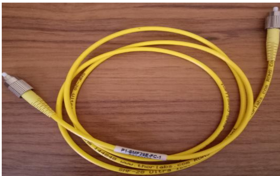
Figure III.1 : Fibre optique monomode P1-SMF-28-FC-1 du fabricant thorlabs
