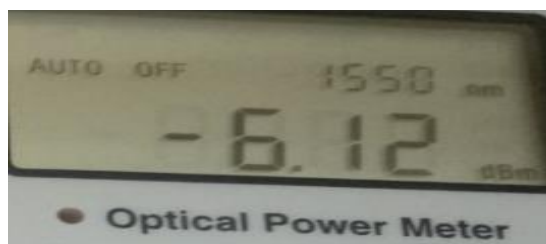
Figure III.10 : puissance reçue sur le wattmètre optique
