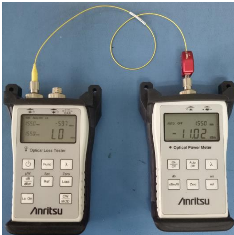
Figure III.30 : Mesure de l'affaiblissement en utilisant le terminateur BFT1
