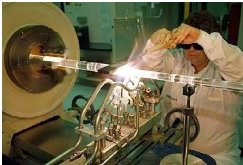
Figure II.1 : Fabrication de la fibre optique (réalisation d'une préforme)
