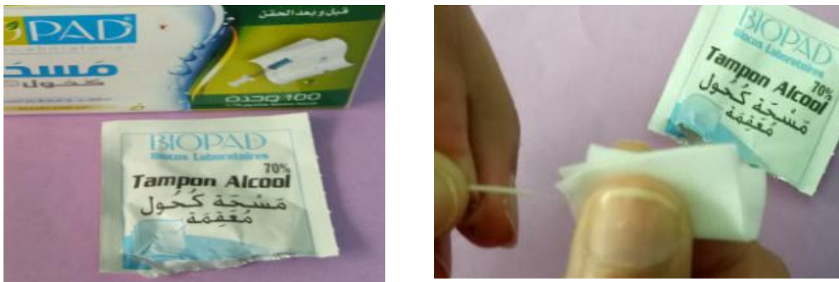
Figure III.18 : Le nettoyage de la fibre optique
