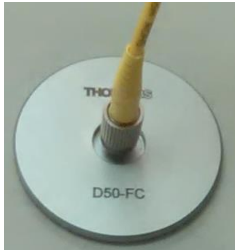
Figure III.36 : Disque de polissage D50-FC de thorlabs
