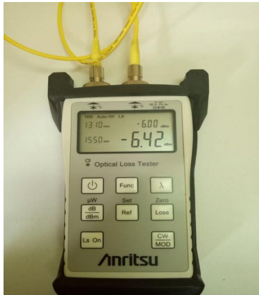
Figure III.5 : Mesure de la puissance reçue
