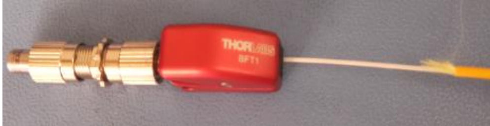
Figure III.29 : Etape « 4 » de la terminaison
