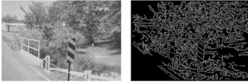
**Figure II.10 : Application du filtre de canny**
