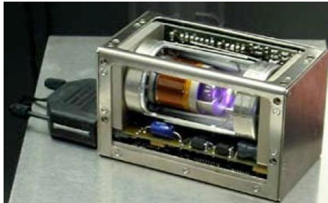
Figure 5 : Horloge atomique [18].
