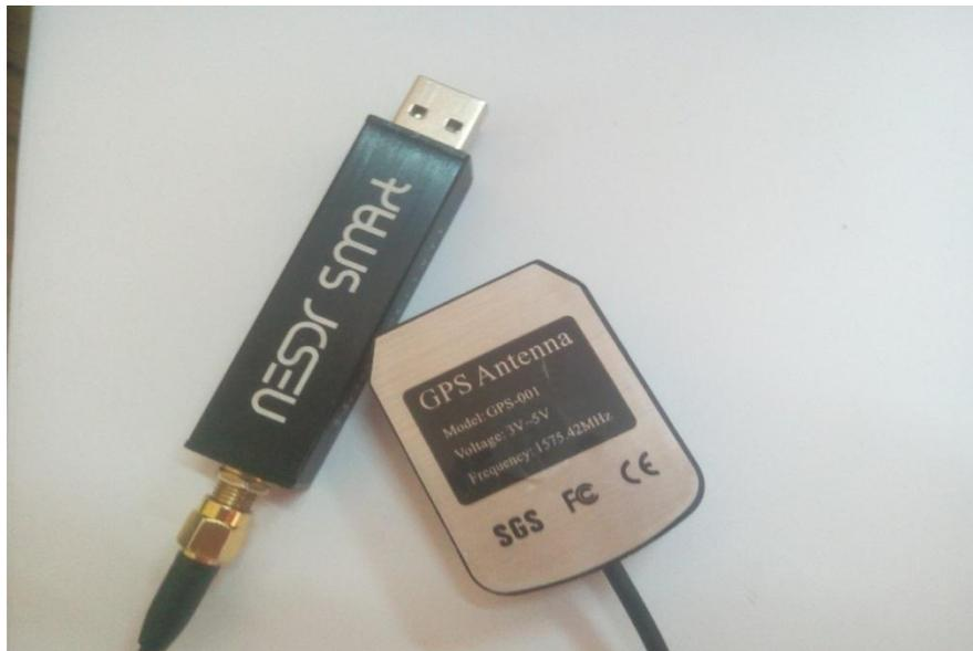
Figure 39 : USB SDR, Antenne GPS.
