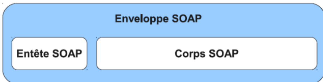
Figure 2.4: Structure d'un message SOAP
