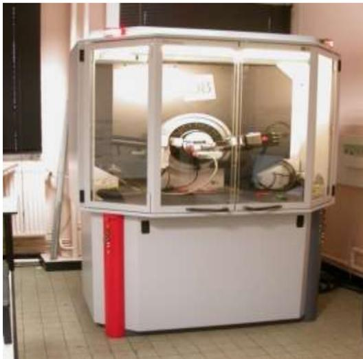
**Figure III.13**: Diffractomètre pour poudre
