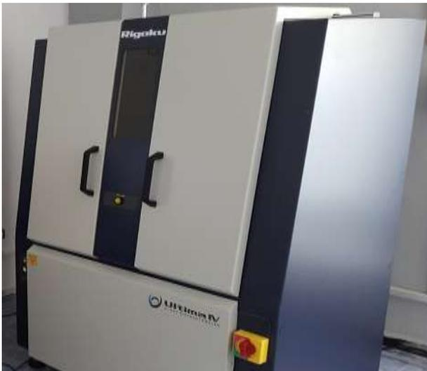
Figure II : L'appareille de diffraction des rayons X
