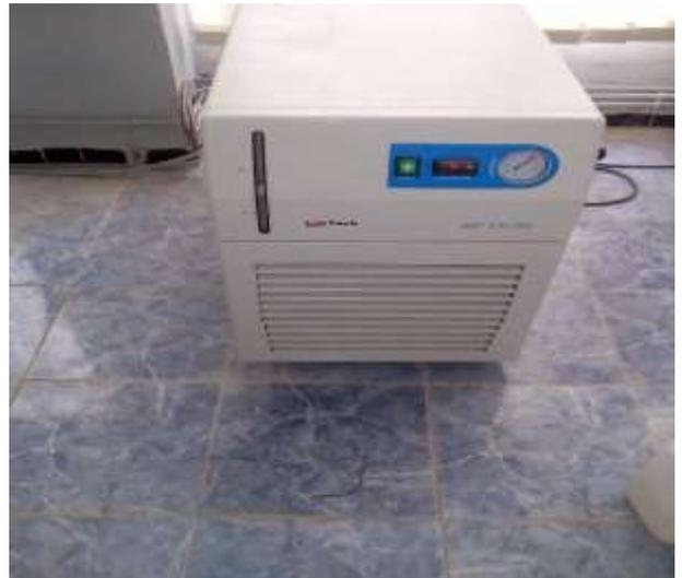
Figure III : Systémie de refroidissement de diffractomètre
