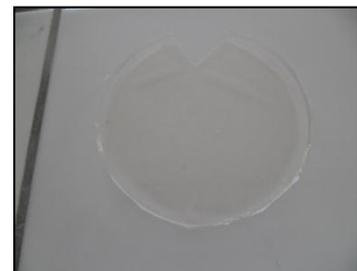
**Photo 1:** Membrane du chitosane pur    **Photo 2:** Membrane du chitosane pur (chitosane dissous dans l'acide acétique)    **Photo 3:** Membrane de PVA pur (chitosane dissous dans la solution de chlorhydrate de glycine)
