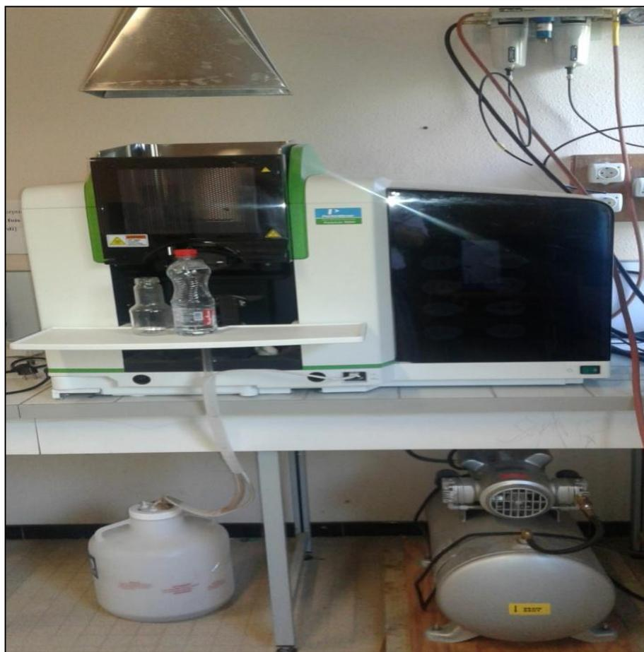
**Photo 6:** Spectrophotomètre d'absorption atomique PERKIN ELMER 900 H.
