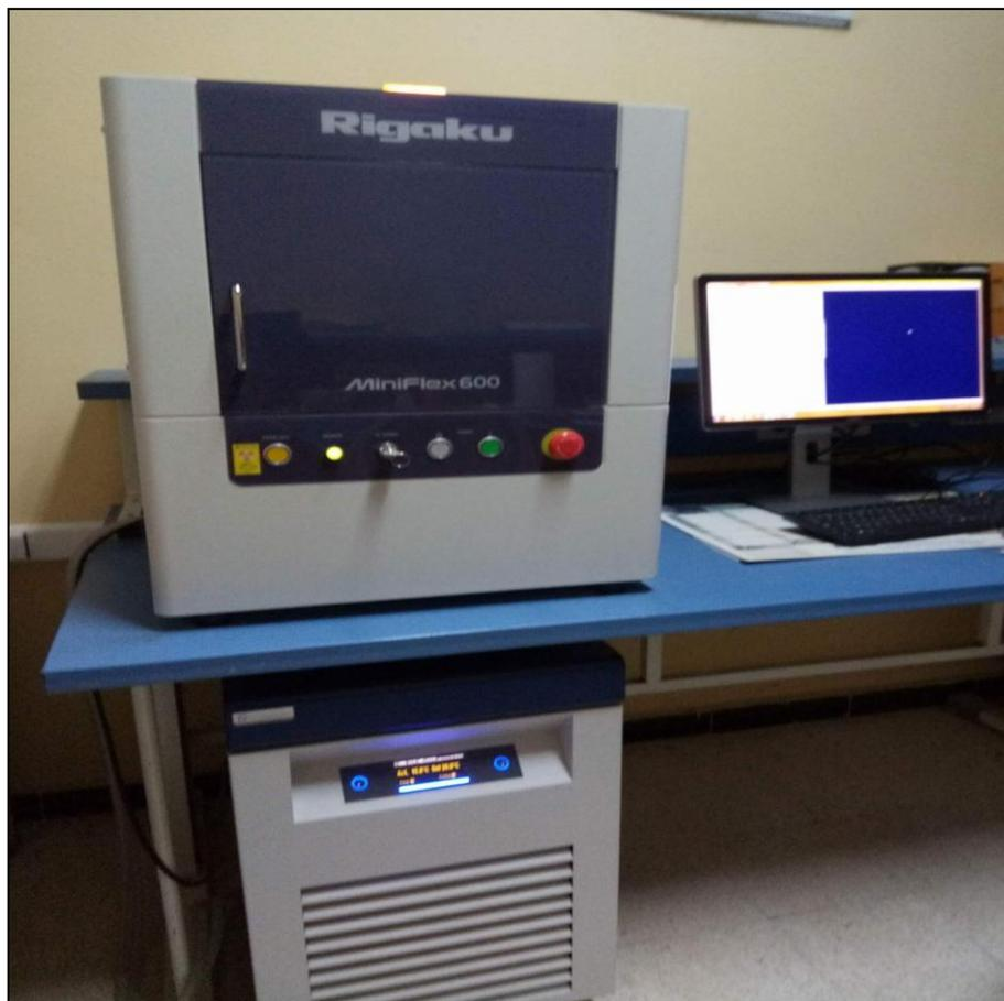
**Photo 10** : Diffractomètre Rigaku MiniFlex 600.
