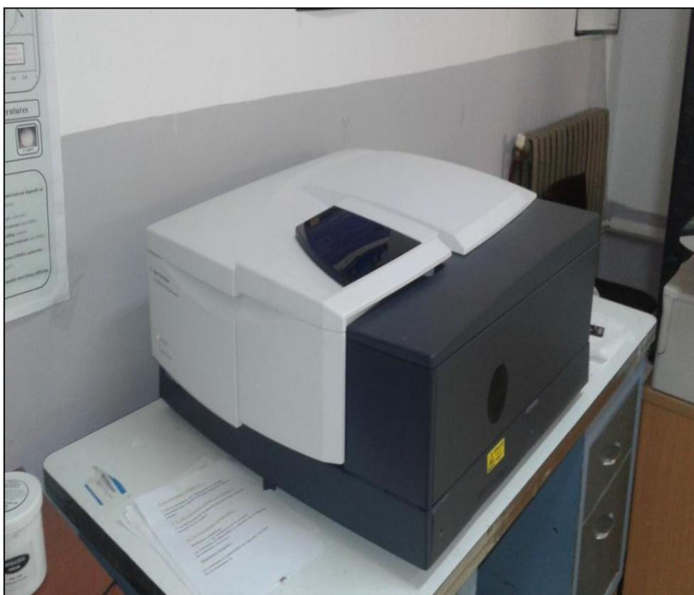
**Photo 7:** Spectroscopie Infra-Rouge de type Cary 640 FTIR Spectrophotometer
