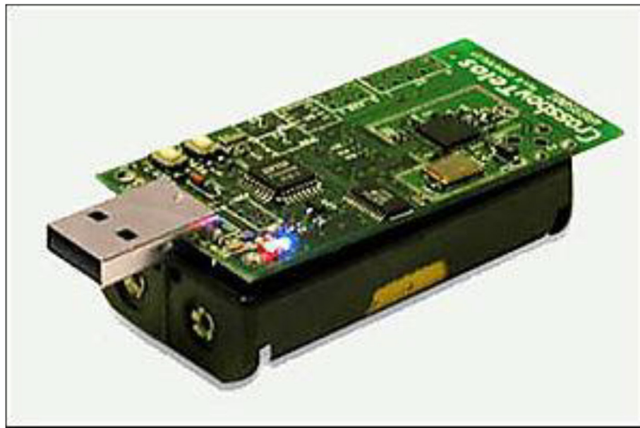
Figure 1.1: Anatomie d'un capteur intelligent Telosb de Crossbow [10]
