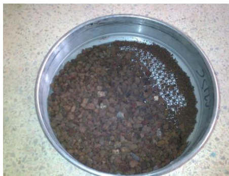
Figure I.8 : Granulat 3/8 de la pouzzolane de Béni-Saf
