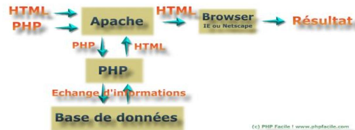
Figure 12 : Schéma du traitement d'un web.
