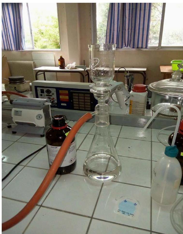
**Figure II. 4 :** Unité de micro-filtration par membrane à 0.45  $\mu\text{m}$
