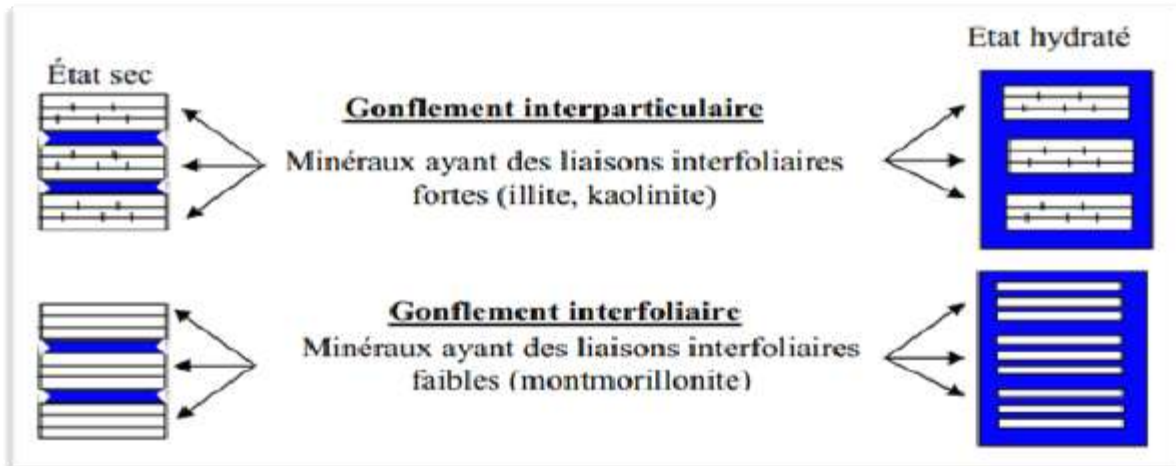
Figure I.3 : Mécanismes de gonflement des argiles par hydratation.
