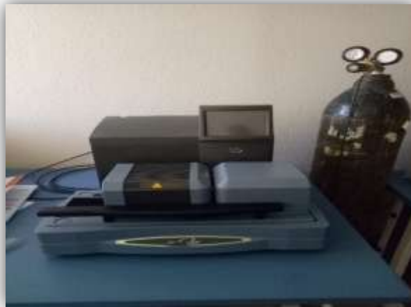
Figure III.8 : appareil d'Analyse thermogravimétrie (ATG)
