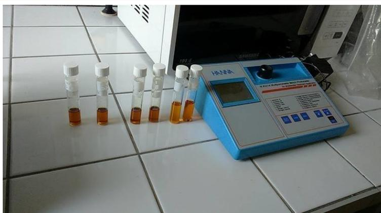
**Figure III.8:** Photomètre de type HI 83214 Multiparameter Bench
