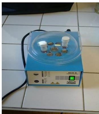
**Figure III.7:** Photomètre de type VELP SCIENTIFICA (ECO 8 Thermoreactor)
