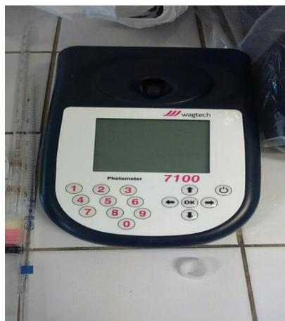
**Figure III.4:** Photomètre de type Wagtech WTD (Wag-WE10441)
