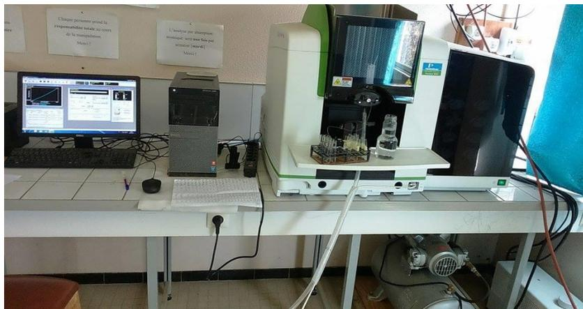
**Figure III.9 :** Spectrophotomètre d'absorption atomique à flamme (SAAF)
