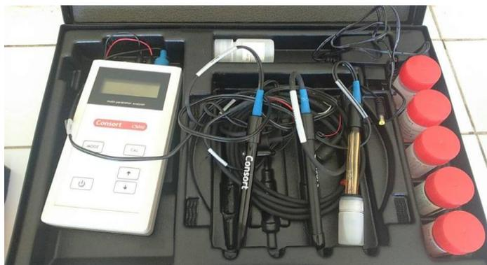
**Figure III.3 : MULTIPARAMETRE C5010T PORTABLE**
