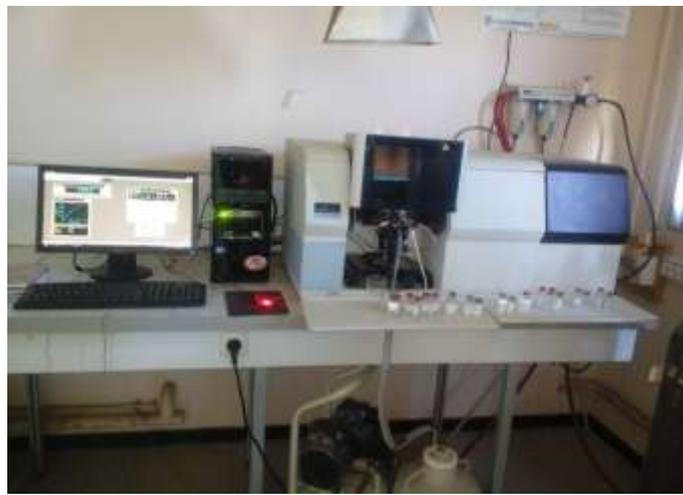
**Figure 5 : Appareil de Spectroscopie Absorption Atomique**
