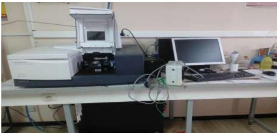
**Figure 6 :** Spectromètre Infrarouge (IR-FT, cary 600 séries).
