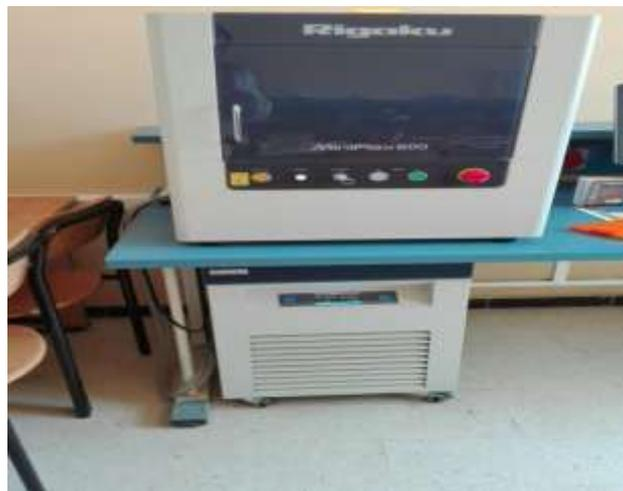
**Figure 8 : Appareil de diffraction des Rayons X**
