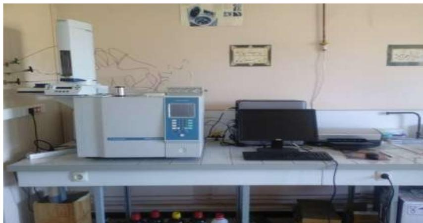
***Figure 11: Appareil de chromatographie en phase gaz.***
