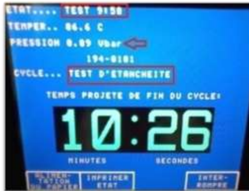
Figure 35 : la phase « TEST » du cycle de fuite d'air
