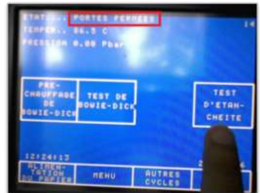
Figure 34: « TEST DE L'étanchéité » affiché sur l'écran digital de stérilisateur
