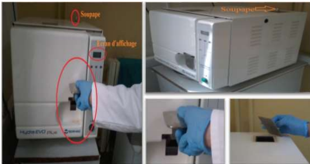
Figure 48: Systèmes de sécurité d'un autoclave Hydra EVO
