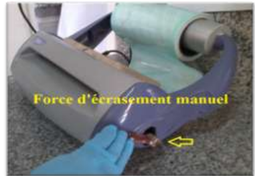
Figure 27: la soudeuse à force d'écrasement manuel
