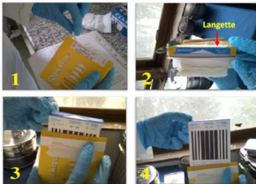
Figure 37: Récupération de la feuille test du paquet test BOWIE-DICK
