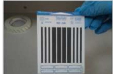
Figure 65: résultat du test de Bowie Dick
