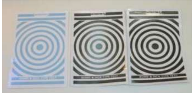
Figure 17 : Changement de couleur de l'encre du test Bowie-Dick
