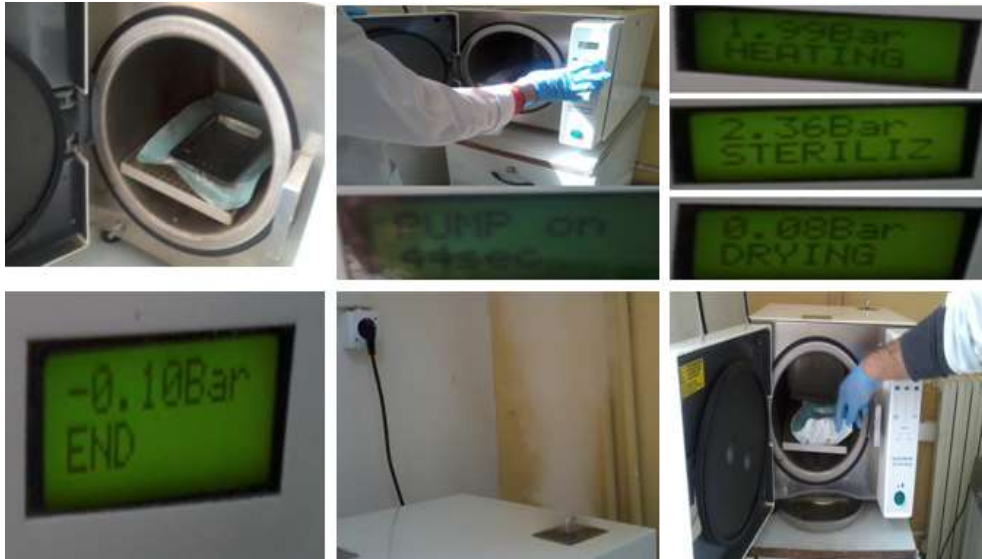
Figure 58: les étapes de la stérilisation proprement dite
