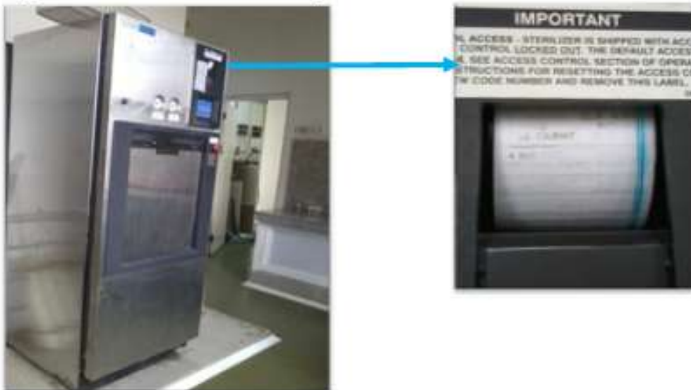
Figure 45: ruban imprimé du rapport complet de variation de température et de pression
