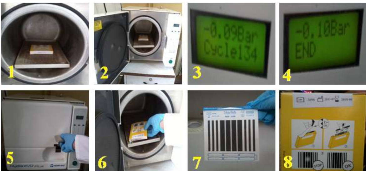
Figure 52: réalisation du test de Bowie Dick
