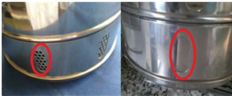
Figure 30: les éclisses avant et après la stérilisation
