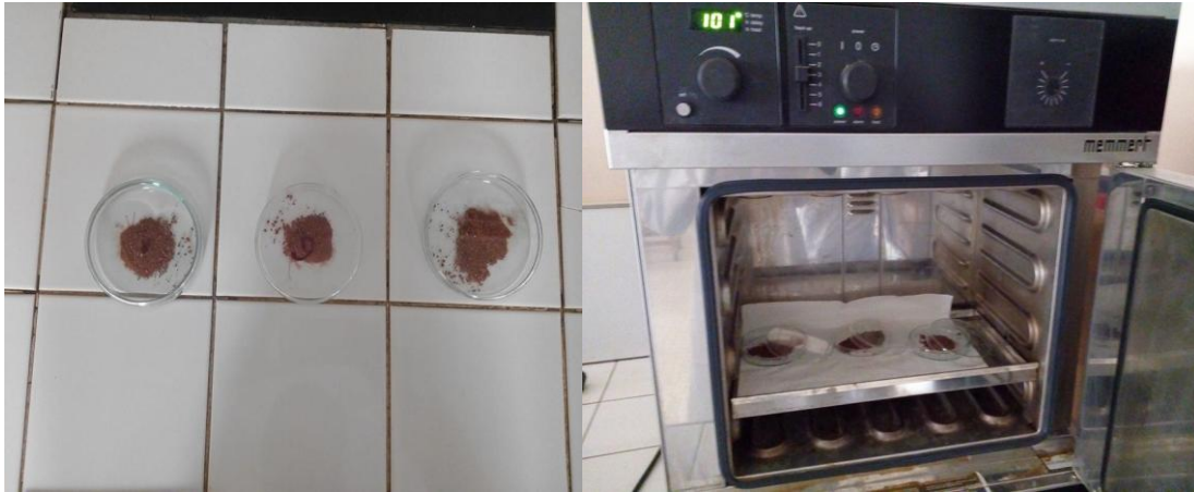
Figure 13 : Détermination gravimétrique de la teneur en humidité par étuvage à 105°C
