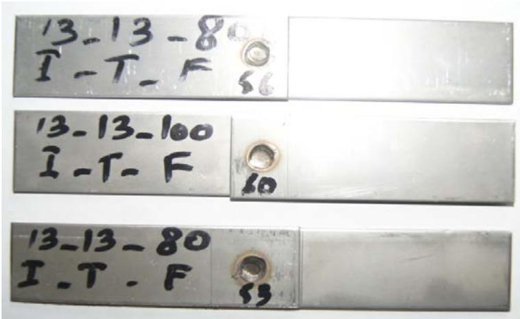
Figure 3.6 : Exemple des pièces assemblées par point des éprouvettes en 304L pour une intensité de 13 Ka et un effort de 7 et 8 bar
