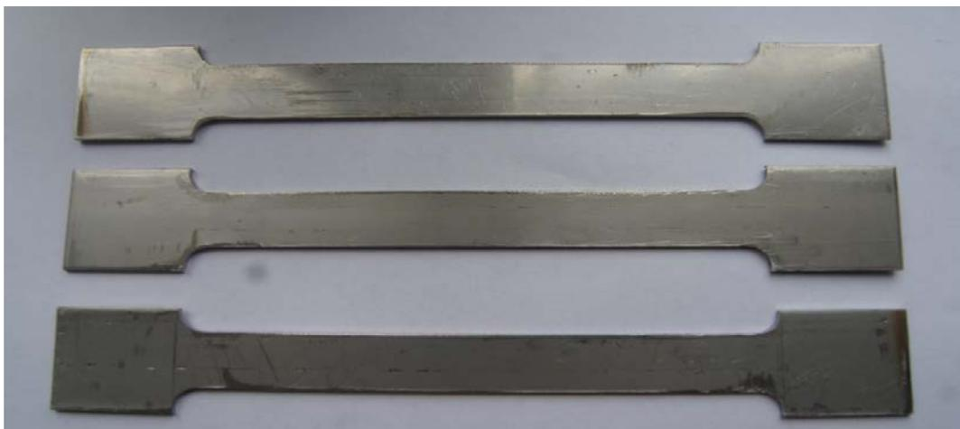
Figure 3.2b : Eprouvettes de traction réalisées en 304 L
