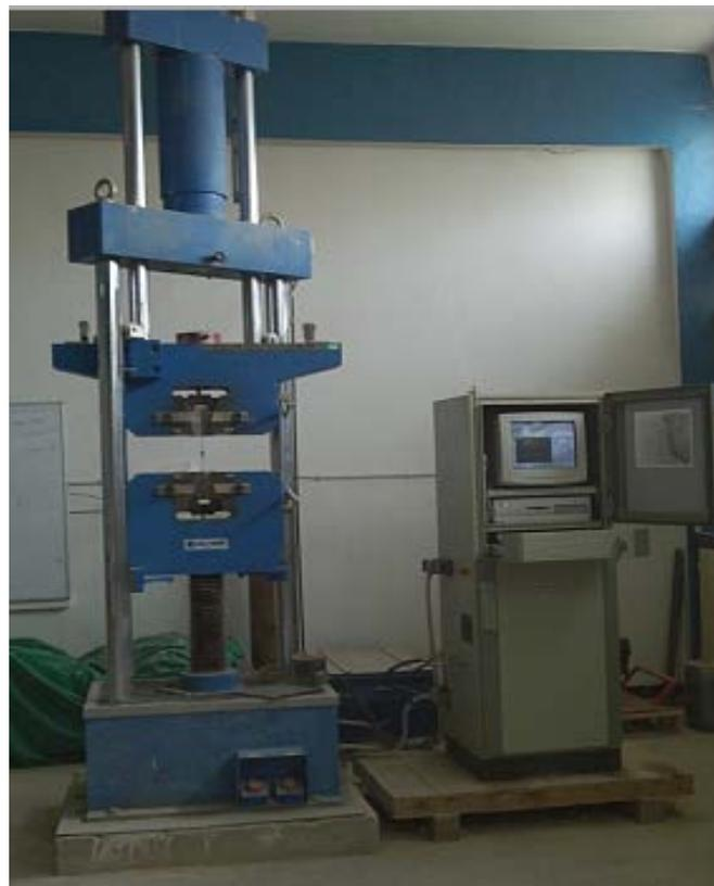
Figure 3.1 : Machine 600 KN pour d'essai de traction
