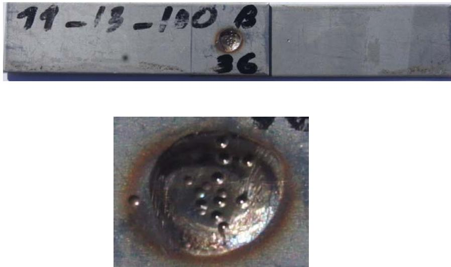
Figure 3.9 : Exemple des essais de dureté HRB sur l'éprouvette
