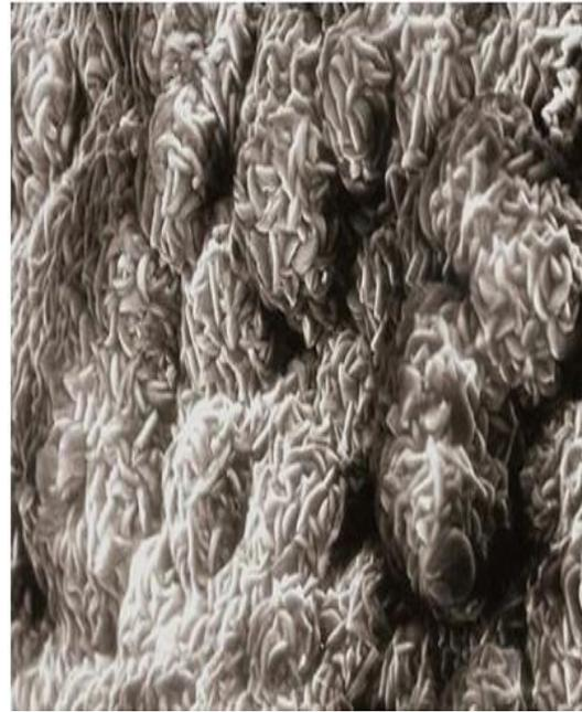
**Figure I.5** : Cristallisations de la brucite sur la surface du béton [53].
