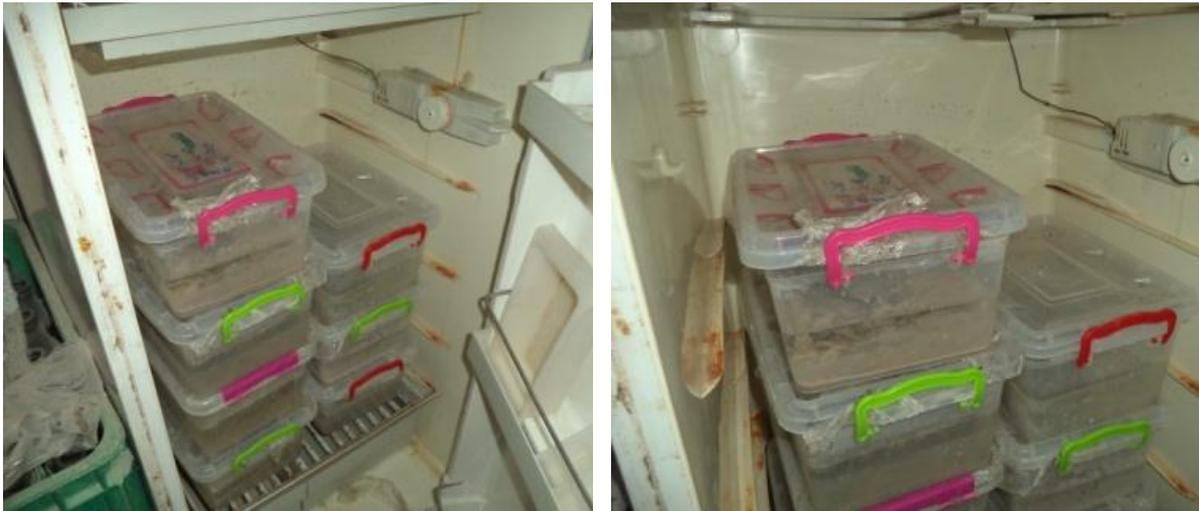
Figure II.11 : Mortiers exposées à basse température 5°C à 5% de MgSO<sub>4</sub>.
