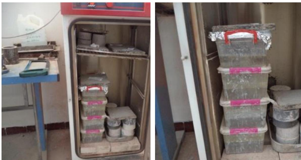
**Figure II.10 :** Mortiers exposés à  $50^\circ\text{C}$  dans 5% de  $\text{MgSO}_4$ .
