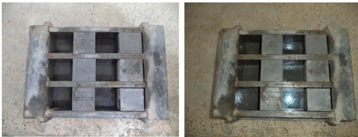
**Figure II.9 :** Moules utilisés pour confectionner les échantillons cubiques de mortier de dimension 40×40×40 mm<sup>3</sup>
