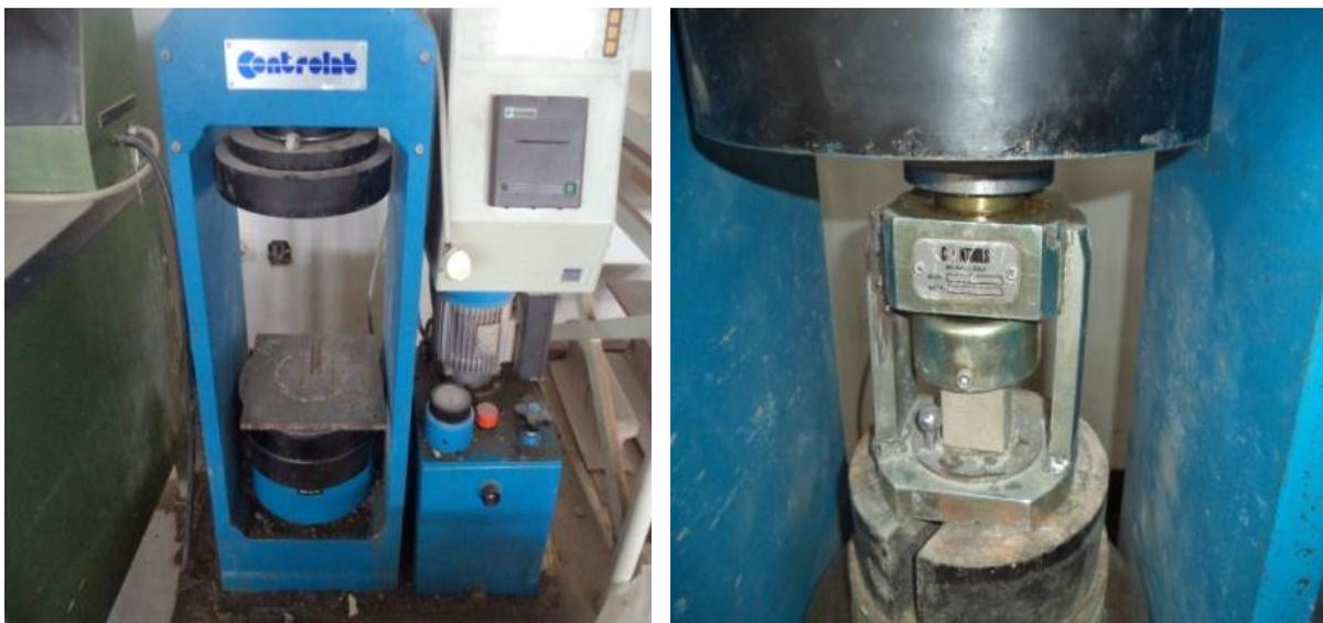
Figure II.13 : Presse utilisée pour les essais de compression.
