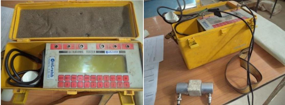
**Figure II.15 :** Appareil aux ultrasons de fréquence 55 KHz.
