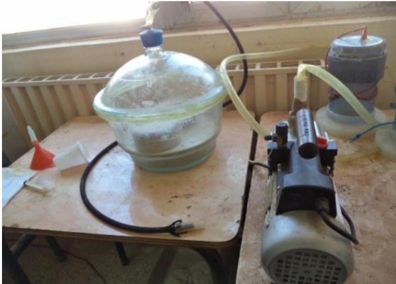
**Figure II.14 :** Dispositif de mesure de la porosité accessible à l'eau.
