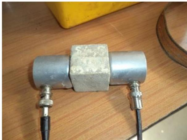
**Figure II.16 :** Méthode de mesure de la vitesse d'impulsion aux ultrasons
