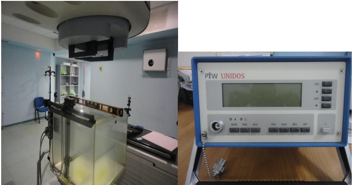
Fantôme automatique de type PTW MP3 avec l'électromètre associé
