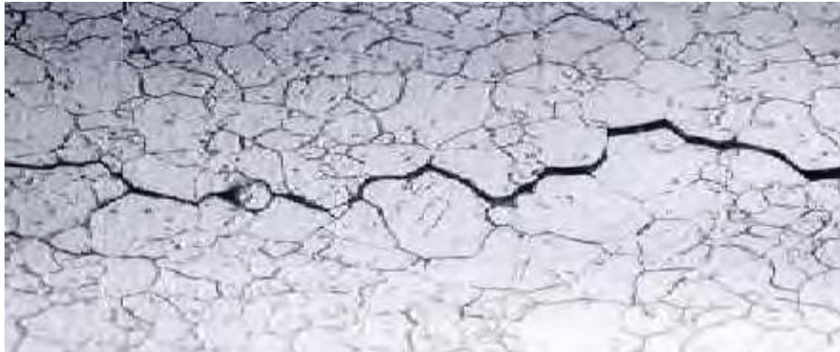
Figure 2.17. Corrosion intergranulaire d'un acier inoxydable [6]
