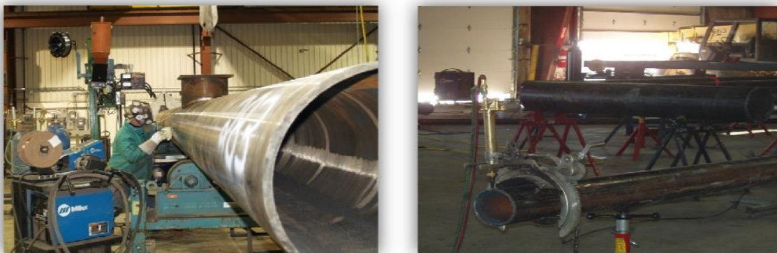
Figure 2.10. Soudage manuelle et automatique des tubes [7]
