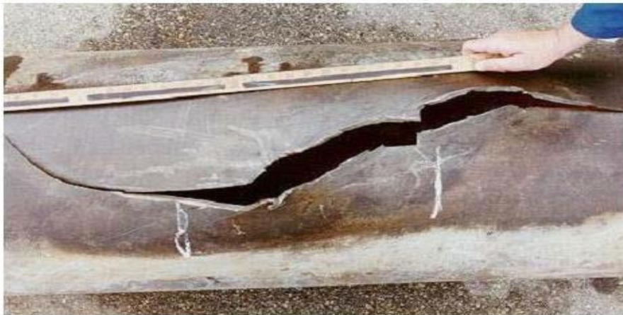
Figure 3.4. Rupture ductile d'un tuyau de Ø. moyen sous l'effet de la pression interne [2]
