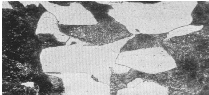
Figure 2.15. Microscopie optique sur un acier corrodé [6]
