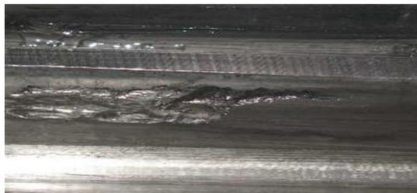
**Figure 3.9 : Ecaillage par fatigue [31]**
