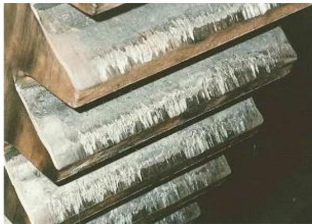
**Figure 3.12 : Grippage localisé sur les têtes de dent [31]**
