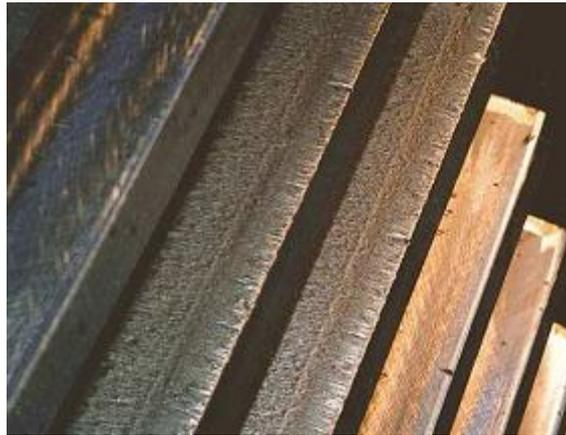
**Figure 3.8 : Grippage couvrant l'ensemble des dents [31].**
