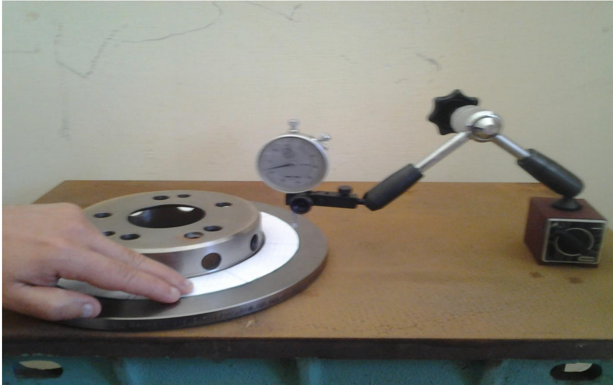
Fig.2.5. Désignation et contrôle de la planéité.
