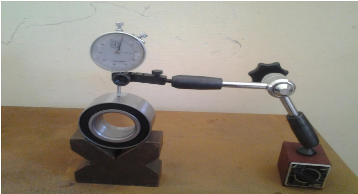
Fig.2.6. Contrôle de la circularité (roulement)
