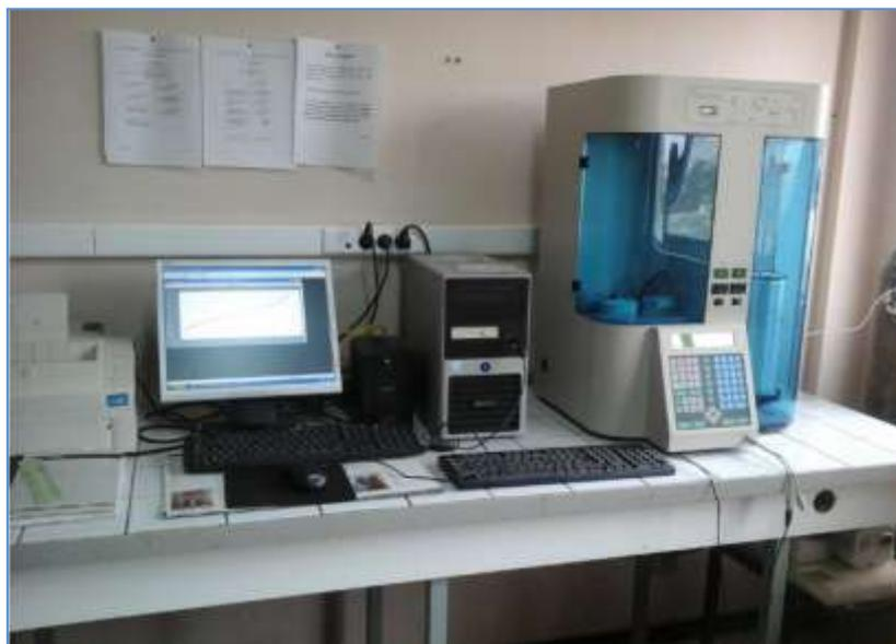
**Figure 4 :** L'appareil d'adsorption/désorption de  $N_2$ .
