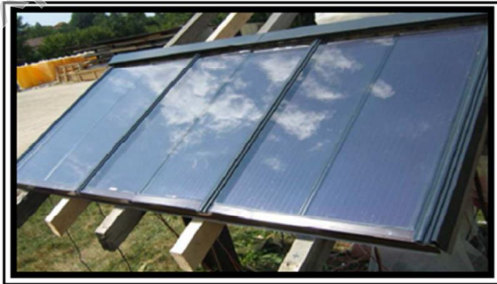
Figure 1.7. Le capteur solaire PV/T hybride à eau [41]
