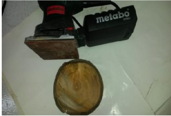
Figure 26 : La ponceuse « Metabo FSR200 Intec Ponceuse Vibrante » dotée d'un papier verre n° 150(Original)
