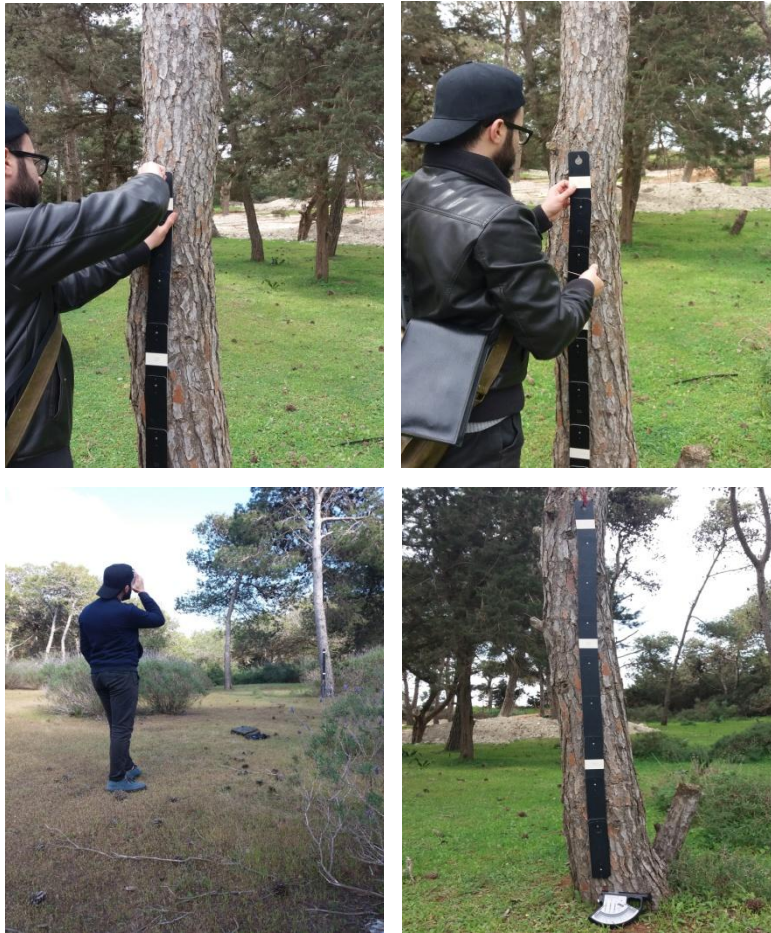
Photo N°02 : Mesure de la hauteur à l'aide de dendromètre de Blum-Leiss.
