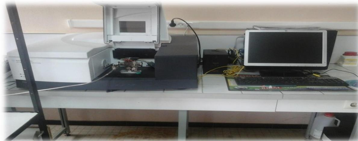
Figure II.8 : Appareil du spectromètre Infrarouge à transformée de fourier (IRTF)
