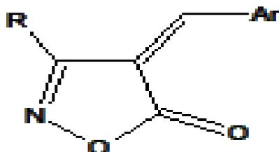
La synthèse des dérivés d'isoxazolone comme le 4-arylméthylidène-3-substitués isoxazole-5(4H)-one implique un couplage de l'acétoacétate d'éthyle, du chlorhydrate d'hydroxylamine et des aldéhydes aromatiques catalysés par un acide ou une base.<sup>[1]</sup>
