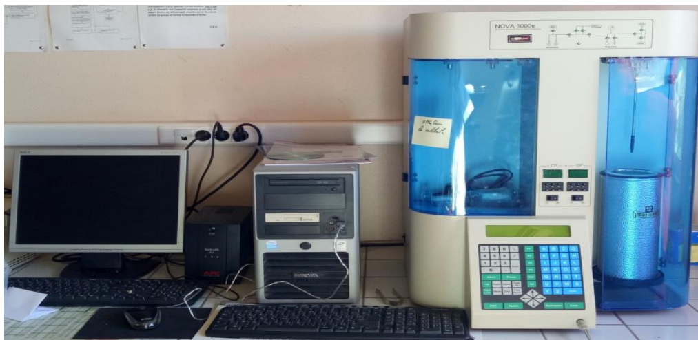
Figure 9 : Appareil NOVA 1000e employé pour les mesures BET.
