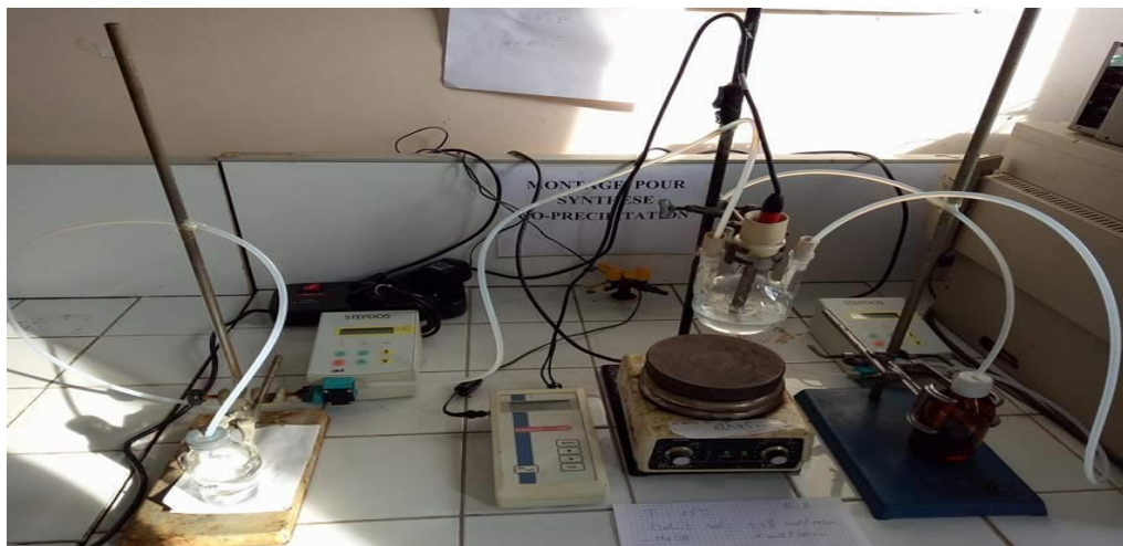
Figure 5 : Montage de préparation des HDLs par la méthode de co-précipitation.
