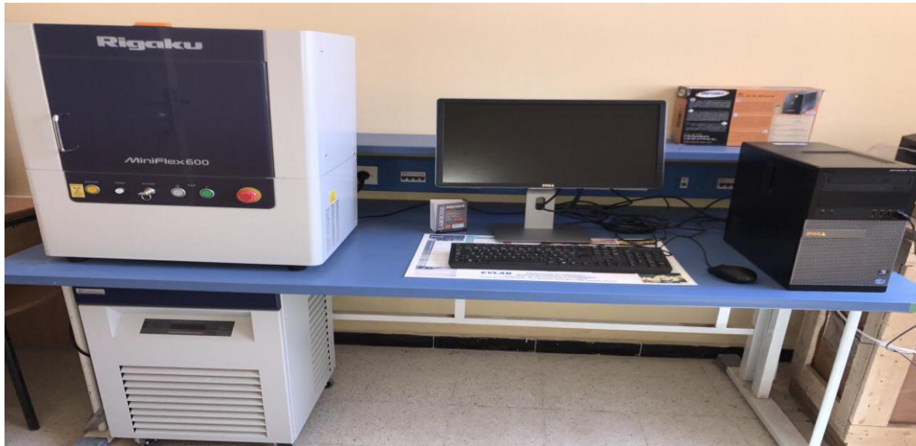
Figure 7 : Appareil DRX Rigaku MiniFlex 600.
