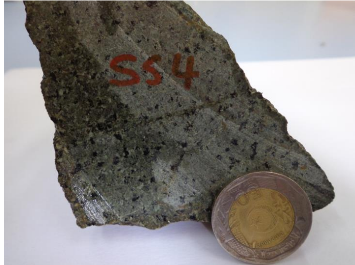
Photo. 17 : échantillons SS 04 (le gabbro).
