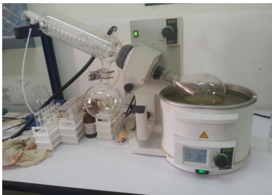
Photo 9 : Evaporateur rotatif (original, 2017)
