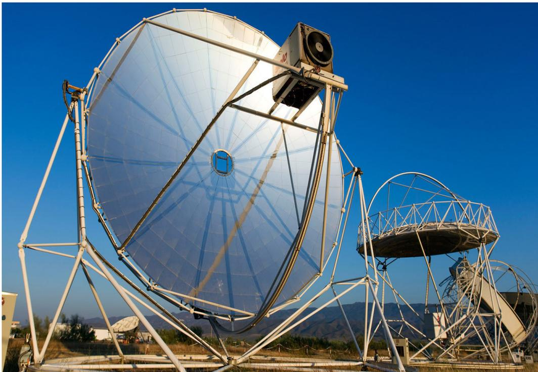
Figure (II.8). Capteur à réflecteur parabolique.
