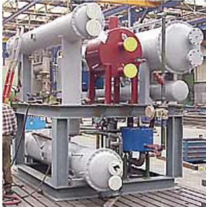
**Figure (I.2).** Machine frigorifique à absorption NH<sub>3</sub>-H<sub>2</sub>O en cours de montage (document Colibri).
