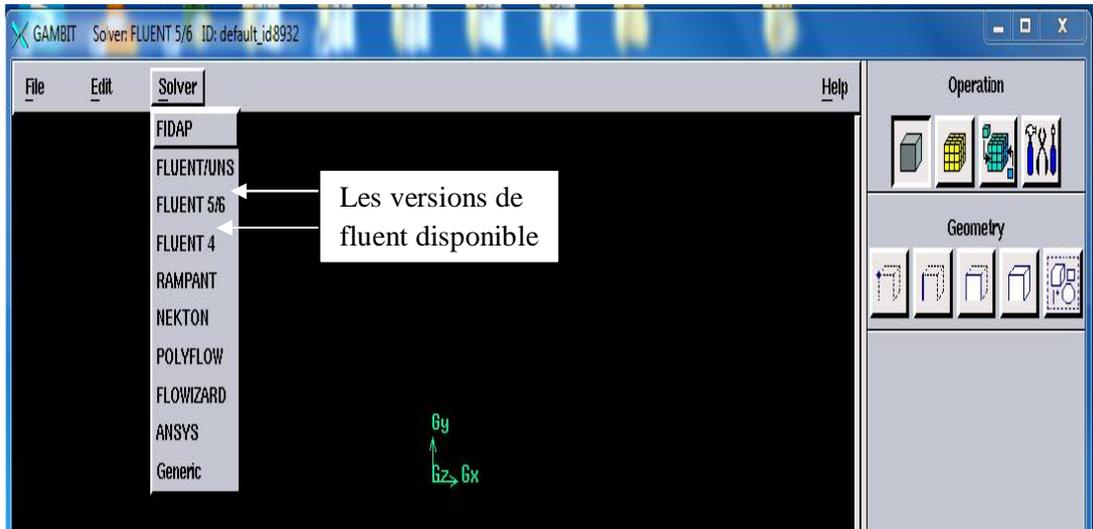
Figure III.5 : Type de solver
