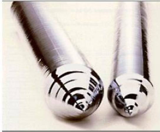
*Figure 1.15 : lingots de Si monocristallin [19]*
